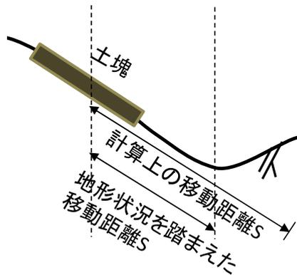
図 2 移動距離 S の設定方法イメージ
