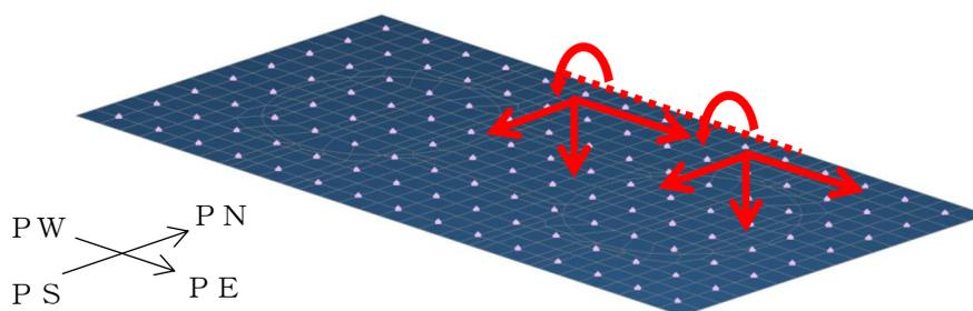
図 4-19 油分離槽の慣性力の概略図
