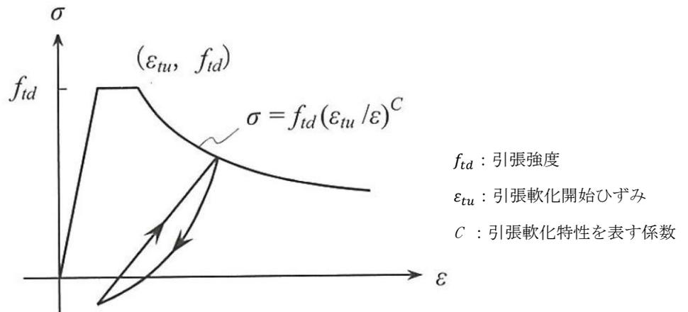
図 4-5 引張応力下における応力-ひずみ関係
