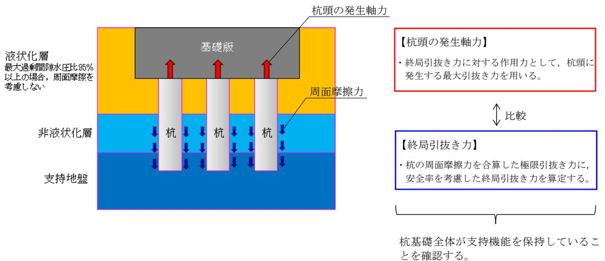
図 5-56 引抜きに対する支持力評価の概要
