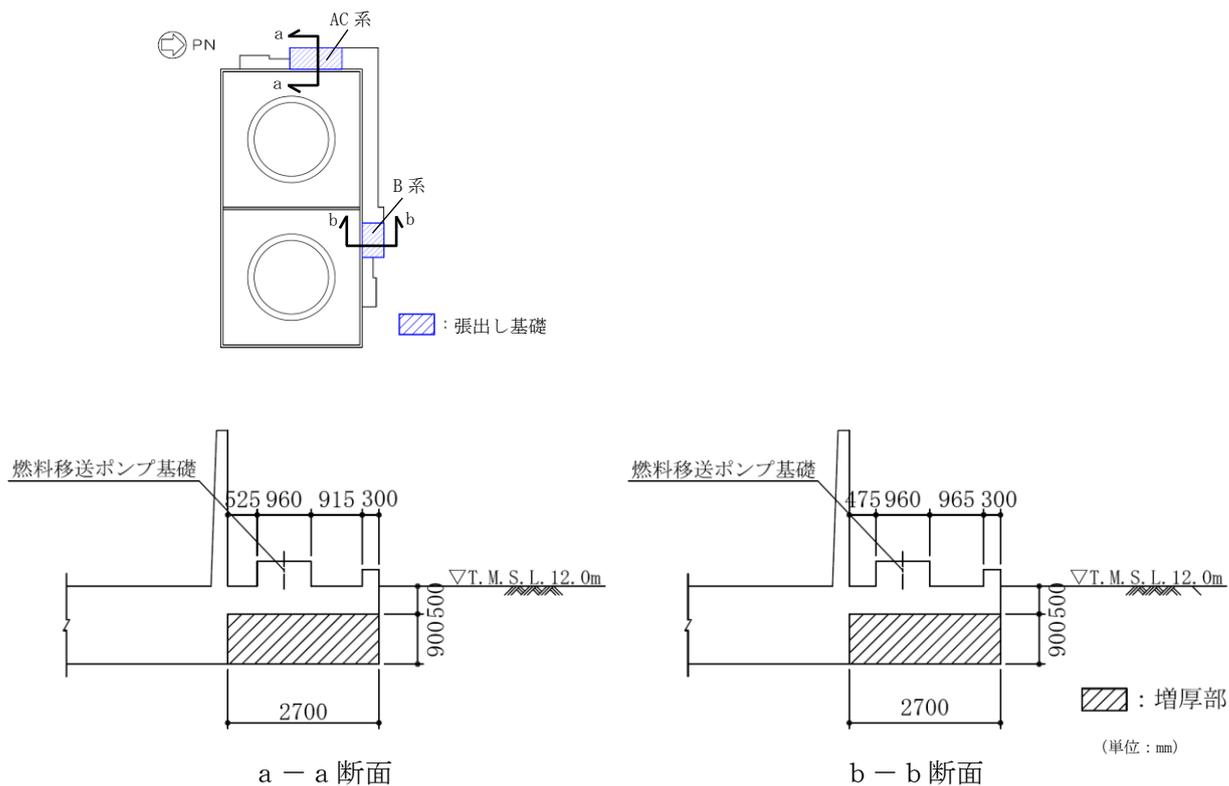
図 3-14 張出し基礎の構造図
