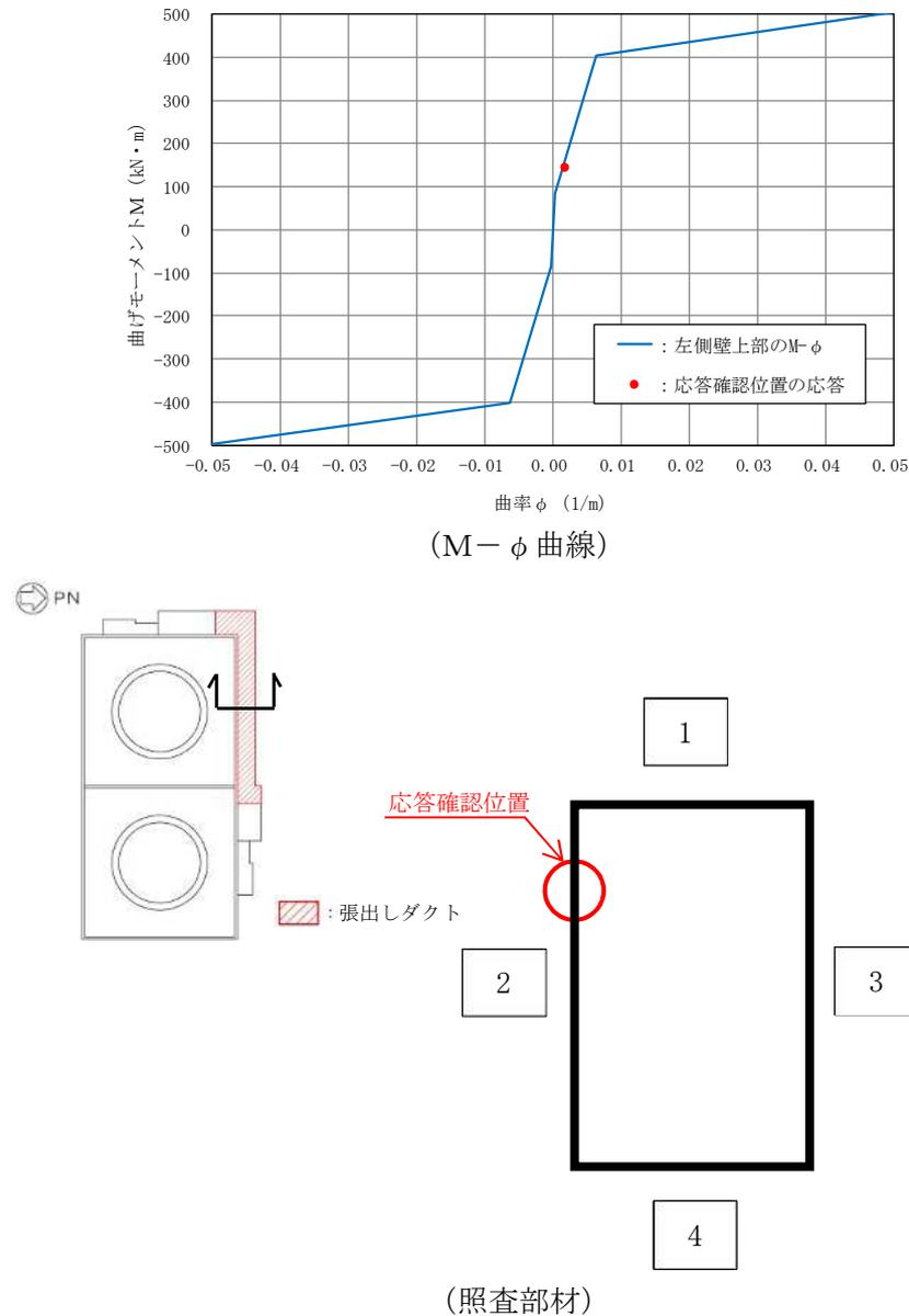
図 4-5 張出しダクトのPHb適用部材のM- $\phi$  曲線
