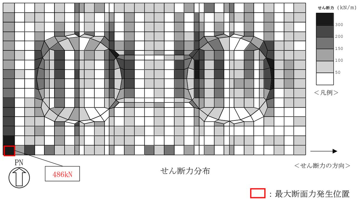
図 6-2 (2) 鉄筋コンクリート部材のせん断力照査が最も厳しくなるケースでの断面力分布図
