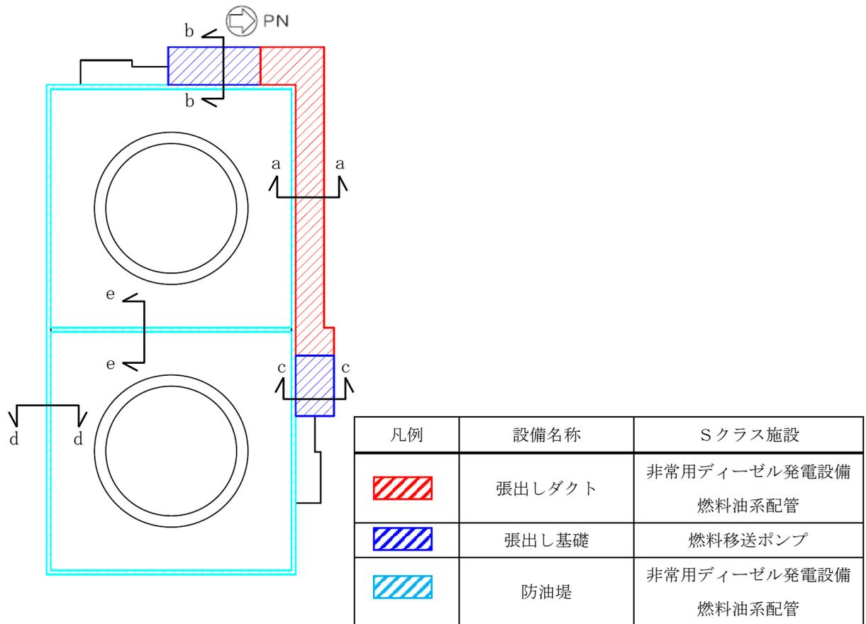
図 1-1 評価対象とする付帯設備
