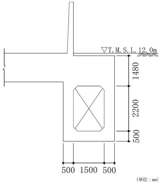
図 1-2 張出しダクト断面図 (a-a 断面)
