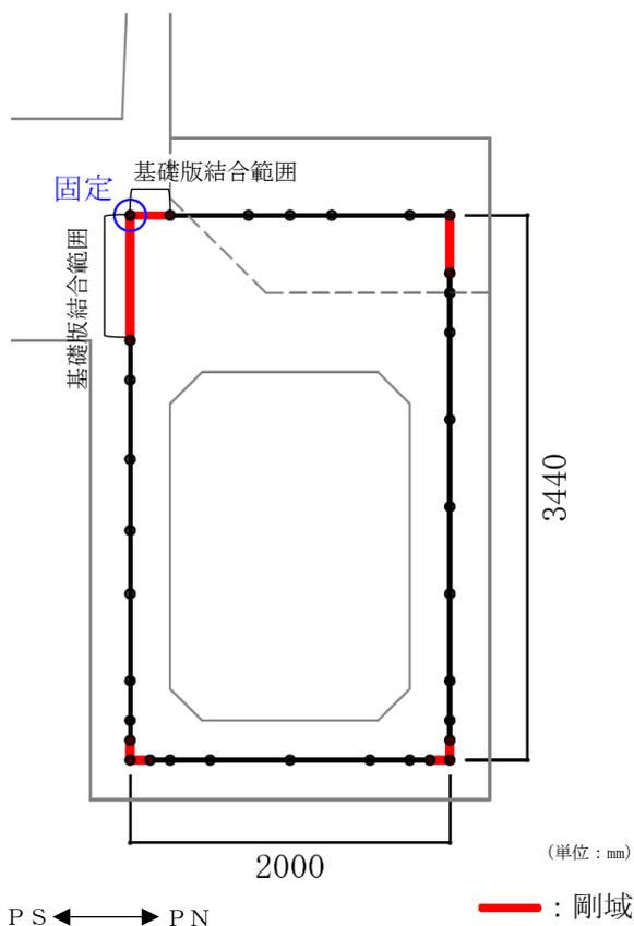
図 3-4 張出しダクトの解析モデル
