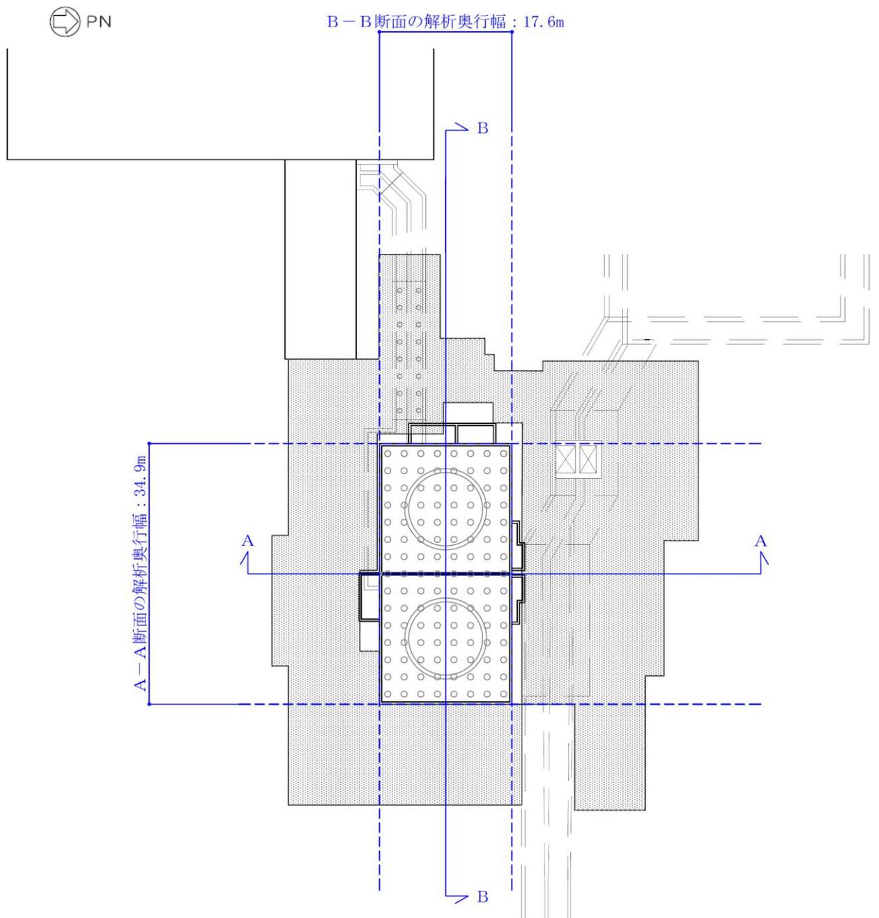
図 3-9 各断面の解析奥行幅の考え方
