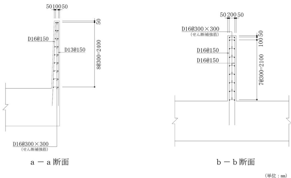
図 3-27 防油堤の概略配筋図
