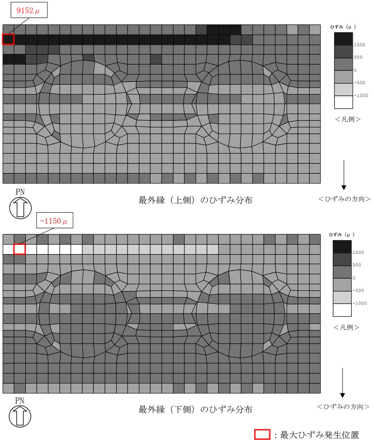
図 6-1 鉄筋コンクリート部材の曲げ軸力照査が最も厳しくなるケースでのひずみ分布図
