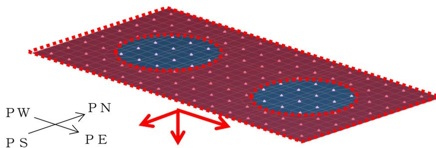
図 4-27 積雪の慣性力の概略図
