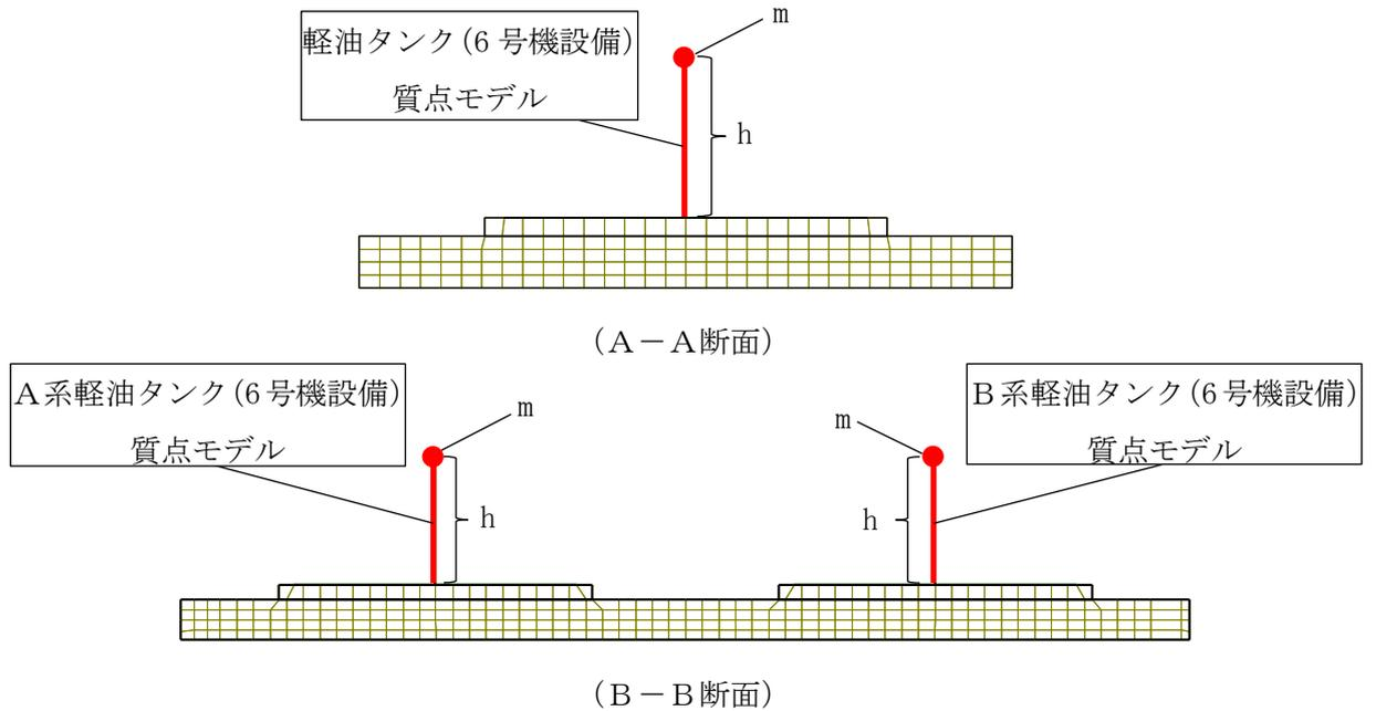
図 3-19 軽油タンク（6号機設備）質点モデル
