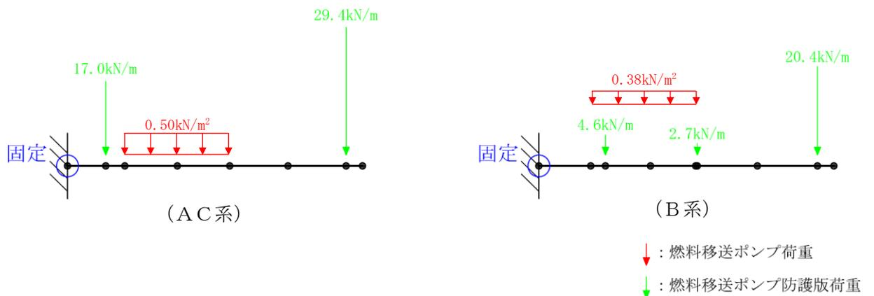
図 3-21 積載荷重の作用箇所位置
