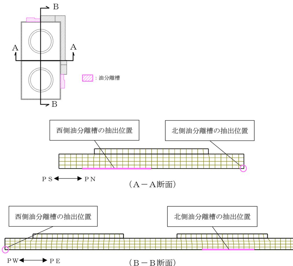
図 4-18 油分離槽の応答加速度抽出位置
