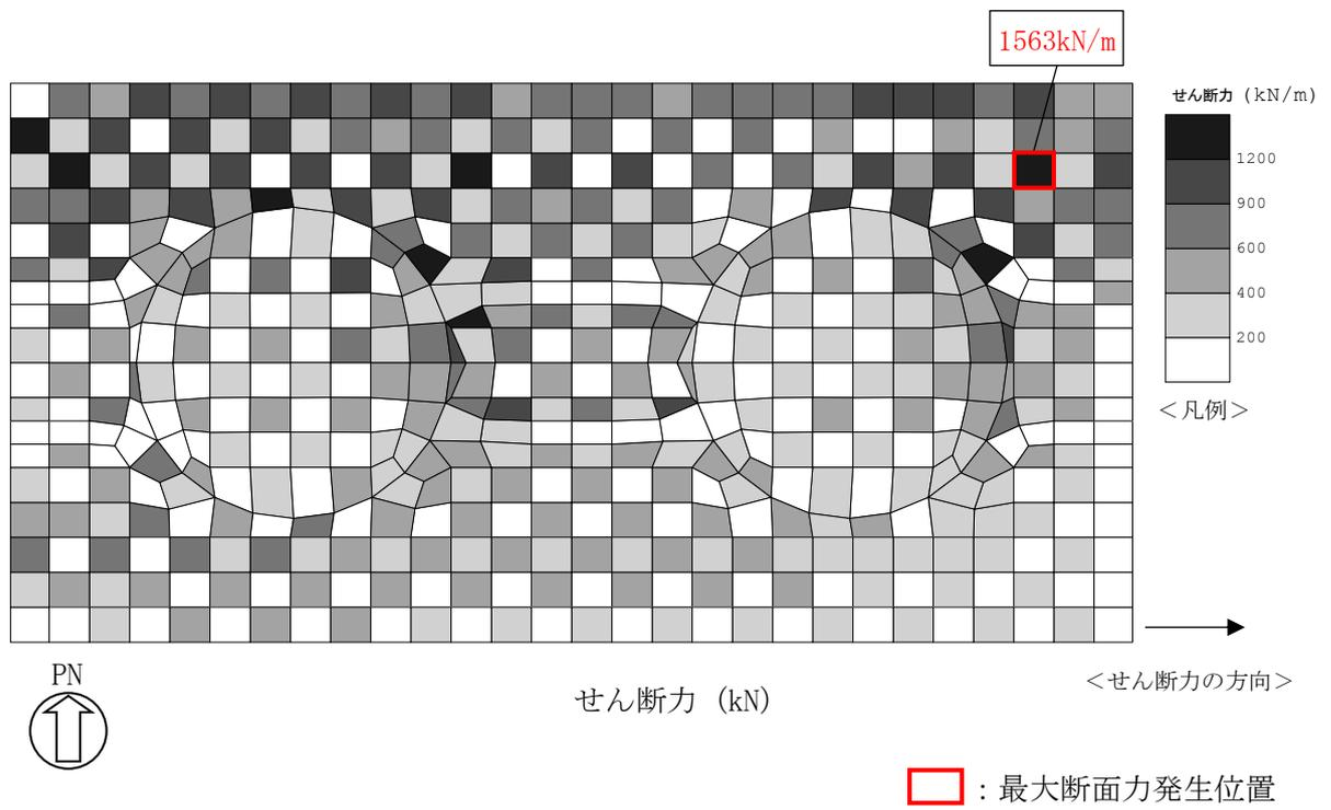
図 6-2 (2) 鉄筋コンクリート部材のせん断力照査が最も厳しくなるケースでの断面力分布図
