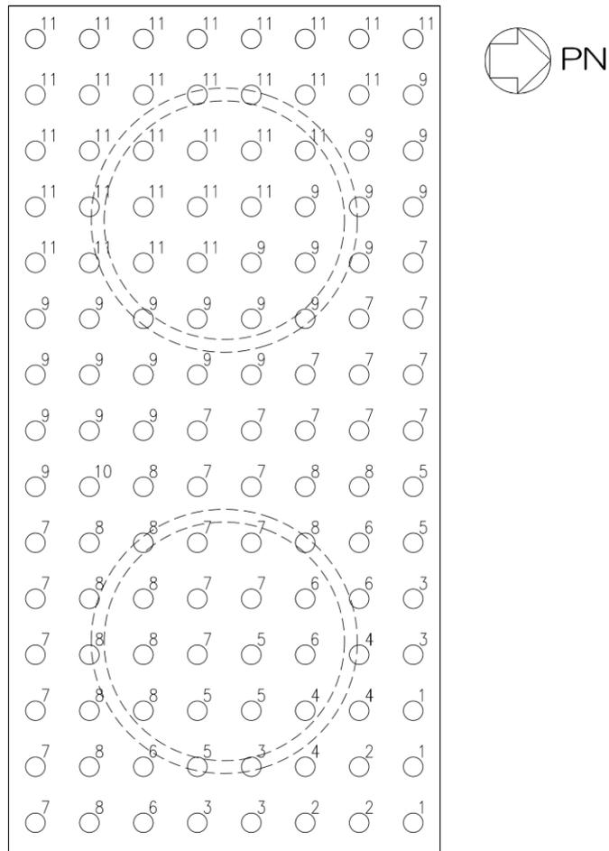
図 2-8 鋼管杭配置図
