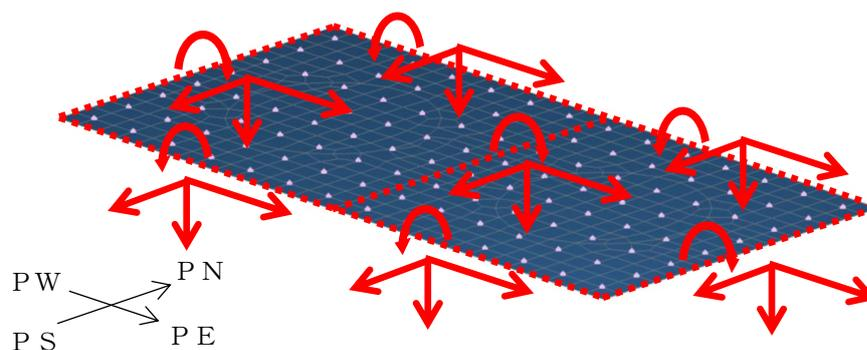
図 4-21 防油堤の慣性力の概略図
