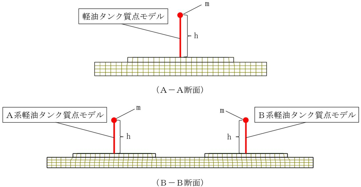
図 3-20 軽油タンク質点モデル
