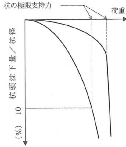
図 3-16 杭の鉛直載荷試験における一般的な荷重—変位関係
