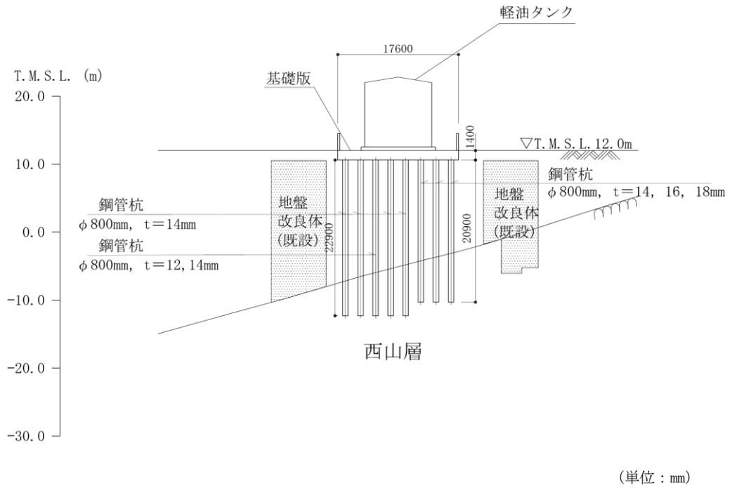
図 2-3 軽油タンク基礎の断面図 (A-A断面)
