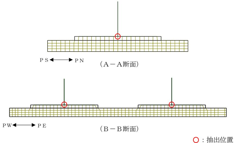
図 4-10 軽油タンクの地震時応答抽出位置
