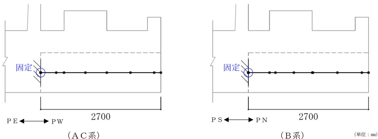
図 3-16 張出し基礎の解析モデル
