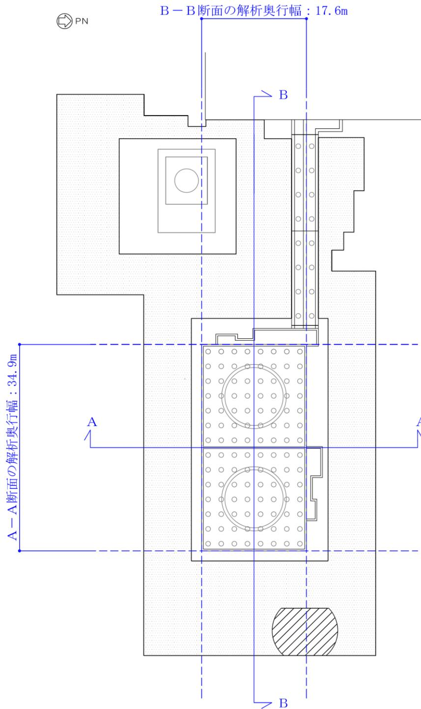
図 3-9 各断面の解析奥行幅の考え方
