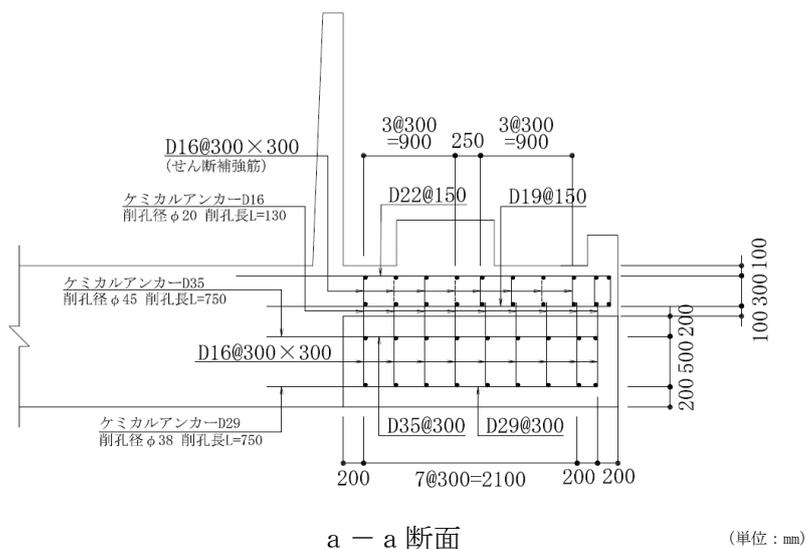
図 3-15 張出し基礎の概略配筋図\*
