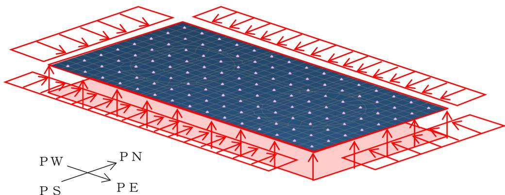
図 4-29 基礎版の土圧及び水圧の概略図
