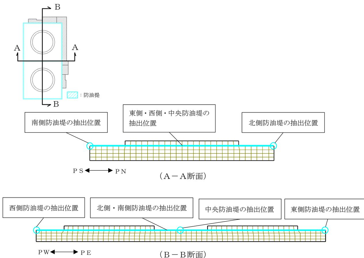
図 4-20 防油堤の応答加速度抽出位置
