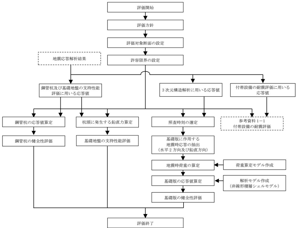
図 2-11 軽油タンク基礎の耐震評価フロー
