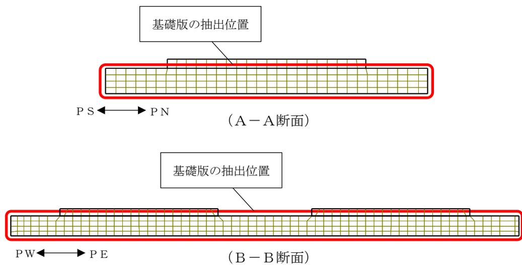
図 4-22 基礎版の応答加速度抽出位置
