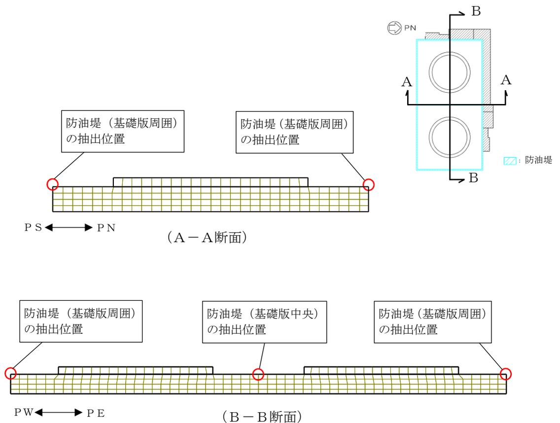
図 3-32 照査用震度を設定するための加速度抽出位置
