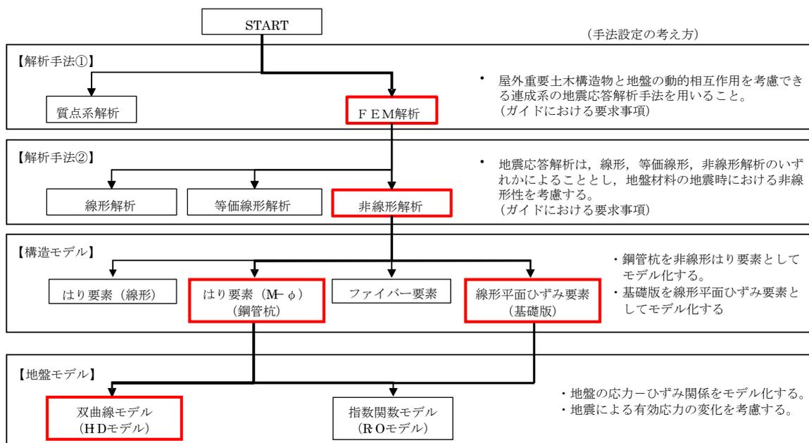
図 3-1 地震応答解析手法の選定フロー
