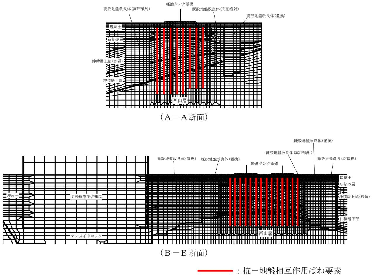
図 3-15 杭-地盤相互作用ばねの配置
