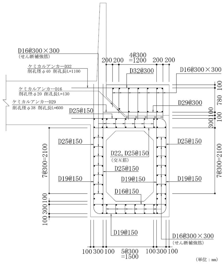
図 3-2 張出しダクトの概略配筋図
