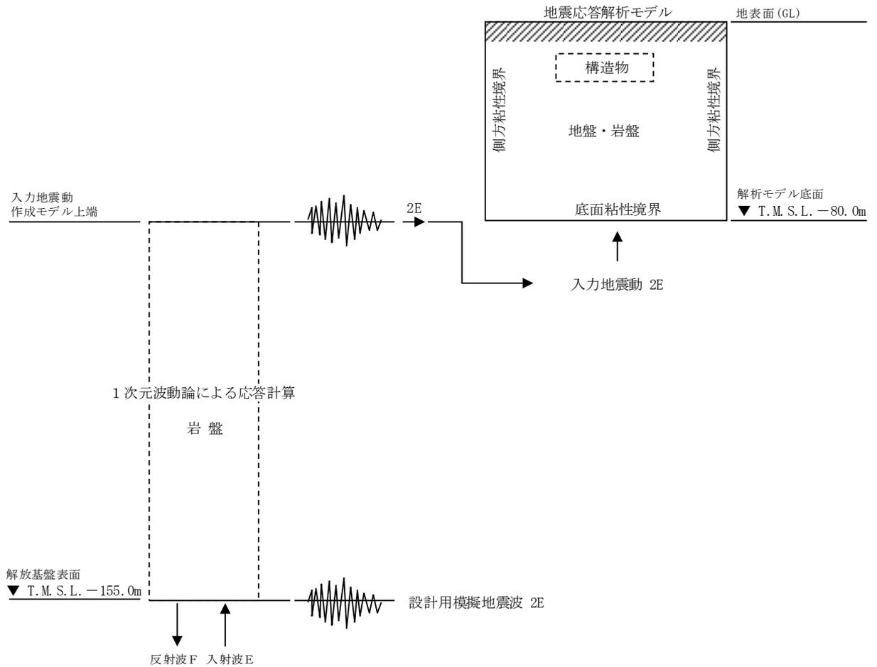
図 5-1 入力地震動算定の概念図
