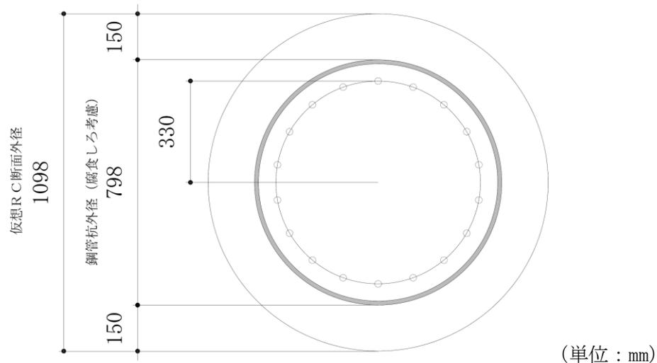
図 3-1 概略補強配筋図 (杭頭補強鉄筋) \*
