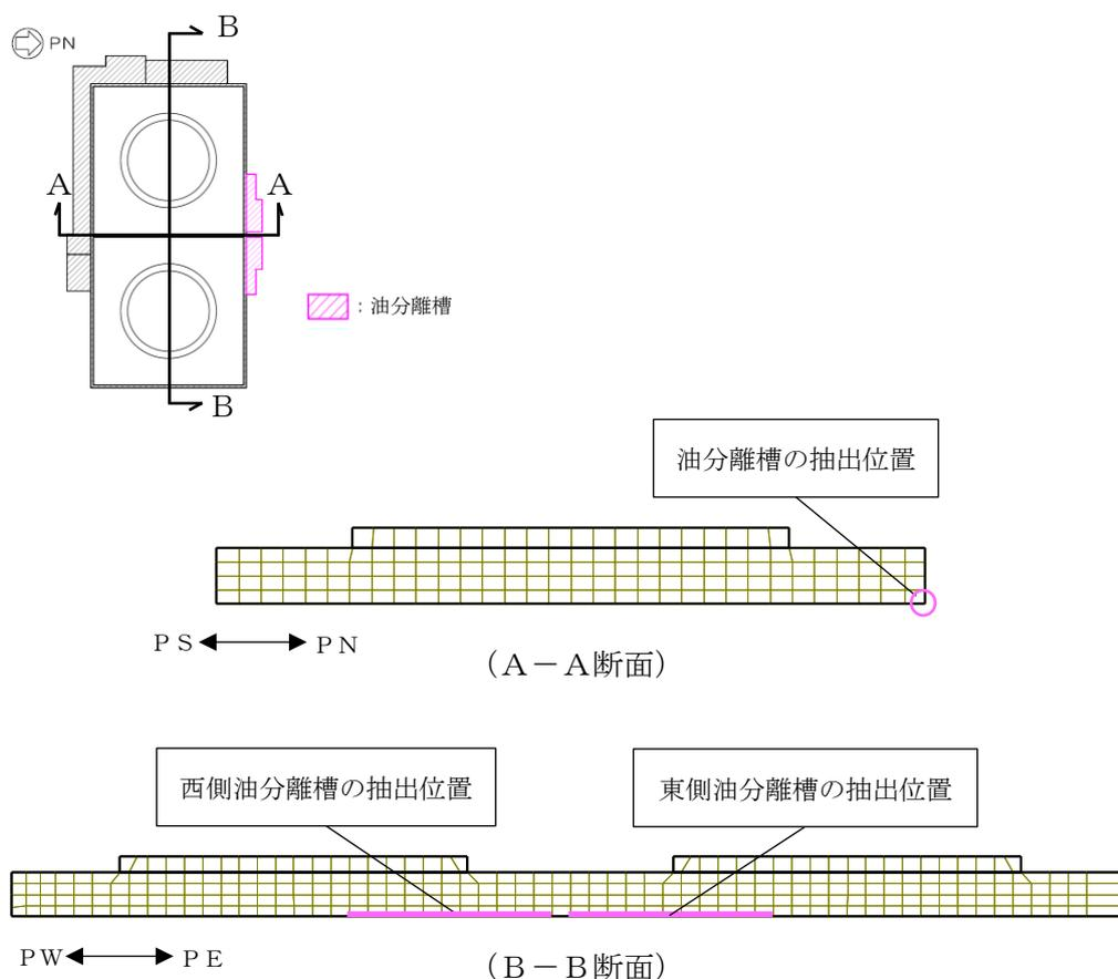
図 4-18 油分離槽の応答加速度抽出位置
