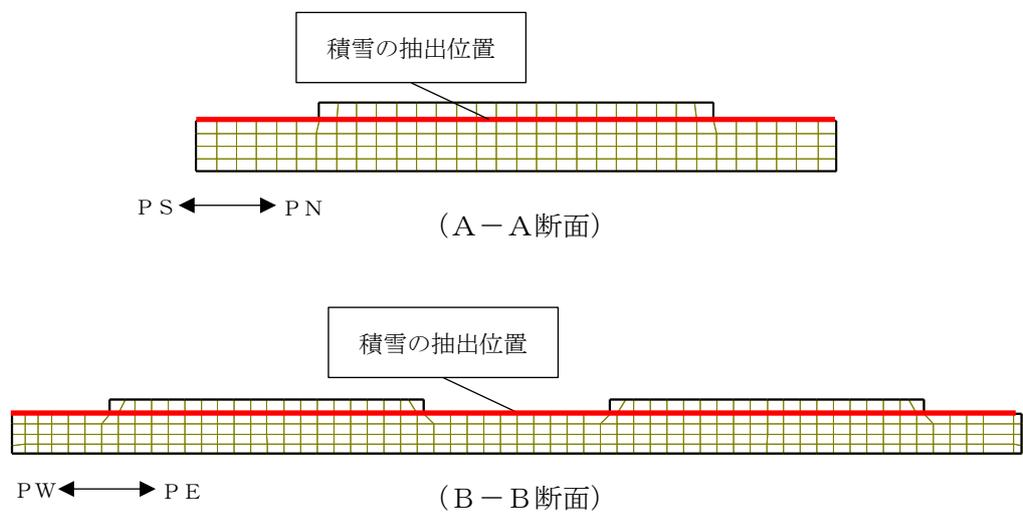
図 4-26 積雪の応答加速度抽出位置
