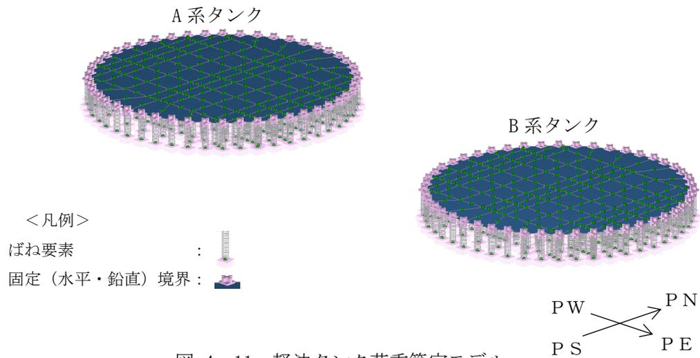
図 4-11 軽油タンク荷重算定モデル
