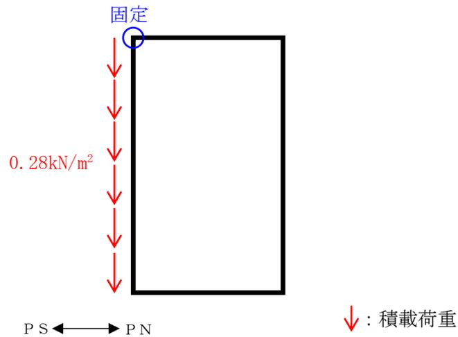
図 3-9 積載荷重の作用位置
