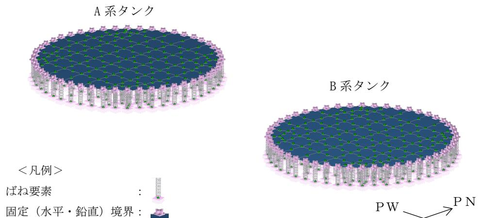
図 4-11 軽油タンク荷重算定モデル
