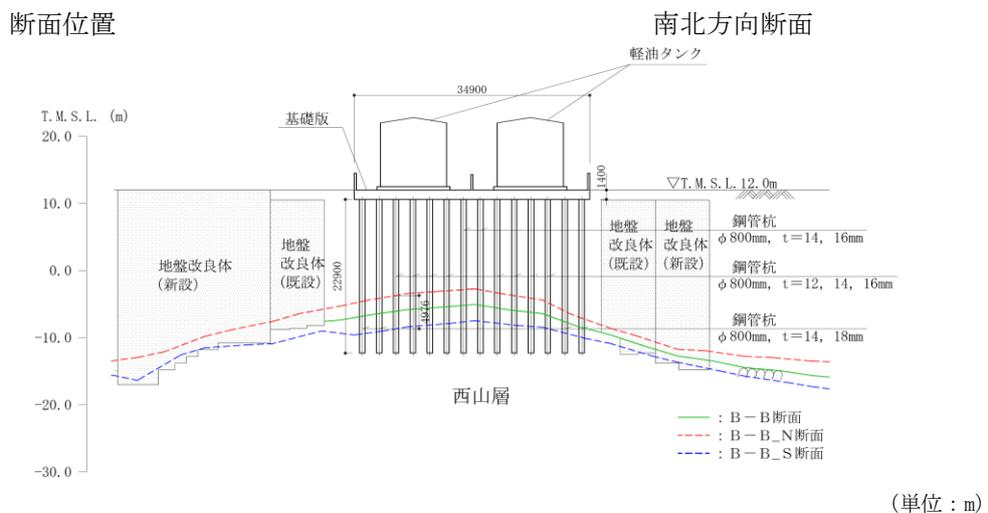
図 1-1 解析断面及び西山層上限面の比較
