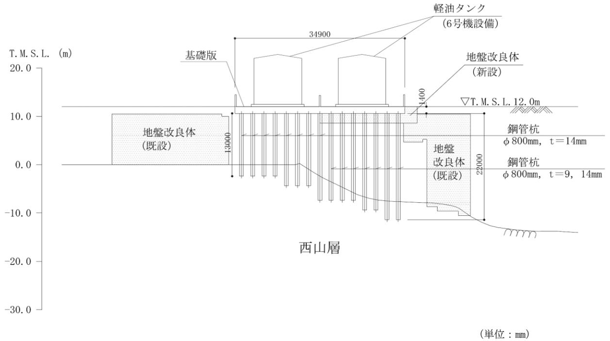
図 2-4 軽油タンク基礎 (6号機設備) の断面図 (B-B断面)
