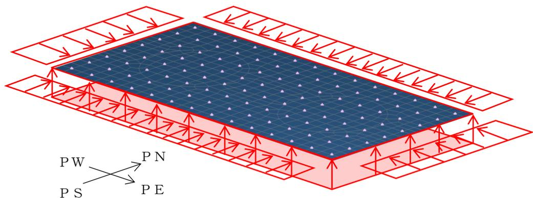
図 4-29 基礎版の土圧及び水圧の概略図
