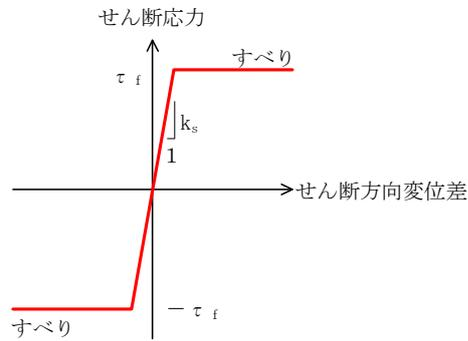
図 3-13 杭-地盤相互作用ばねの力学特性
