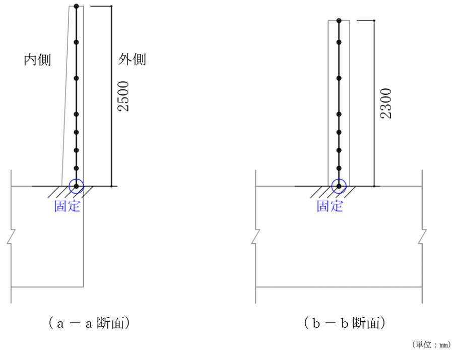
図 3-28 防油堤の解析モデル
