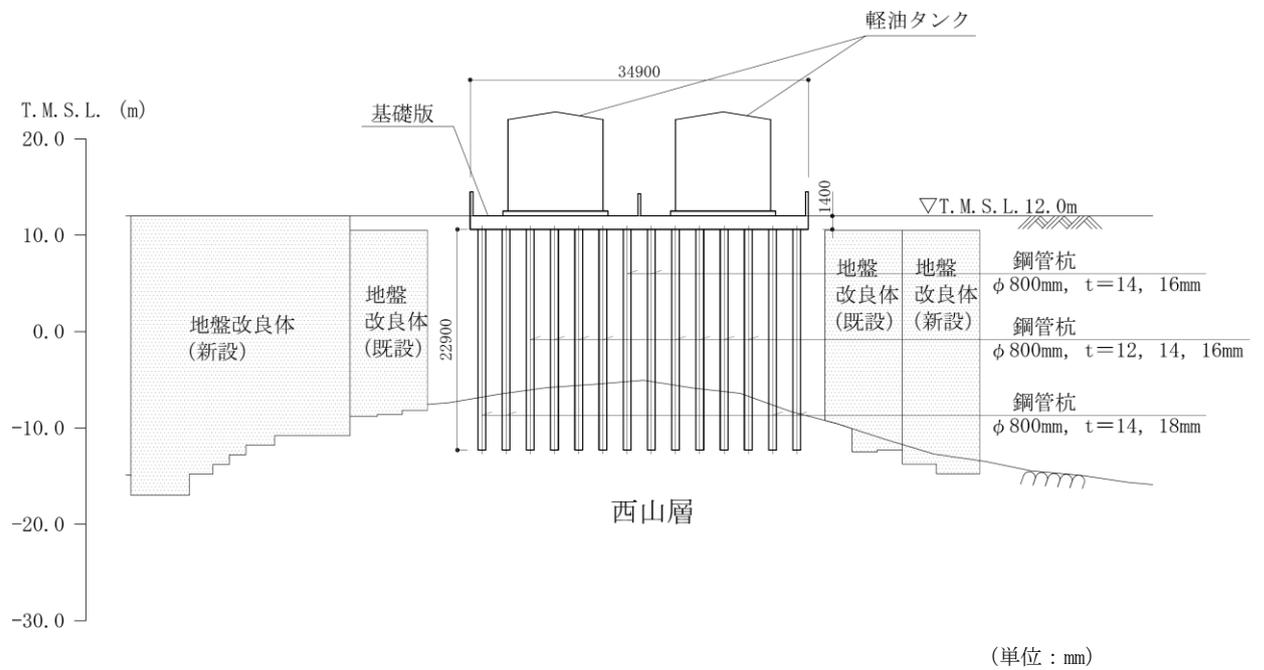
図 2-4 軽油タンク基礎の断面図 (B-B断面)
