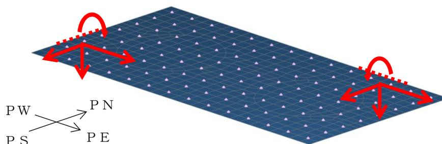
図 4-19 油分離槽の慣性力の概略図
