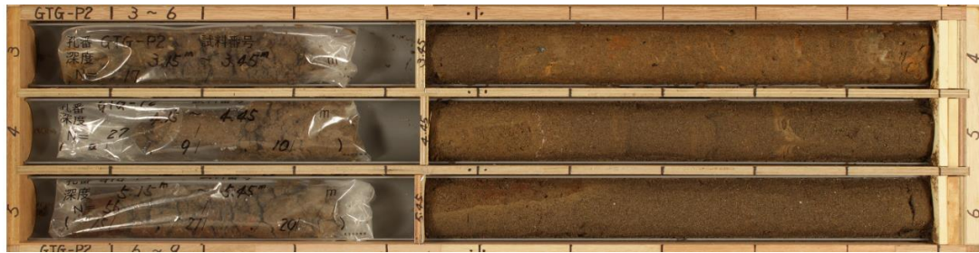
(a) 埋戻土のコア写真 (GTG-P2)
