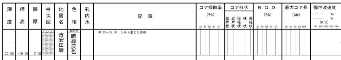
図 2-32 ボーリング柱状図 (改 6-9N)
