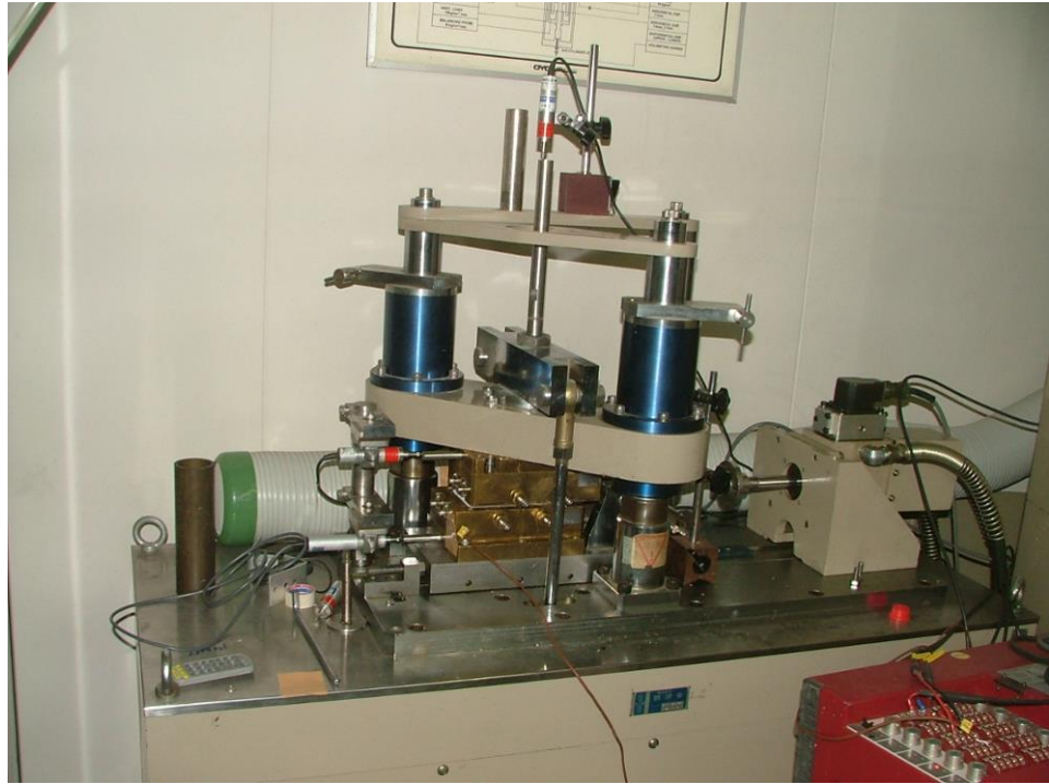
図 3—8 一面せん断試験装置全景
