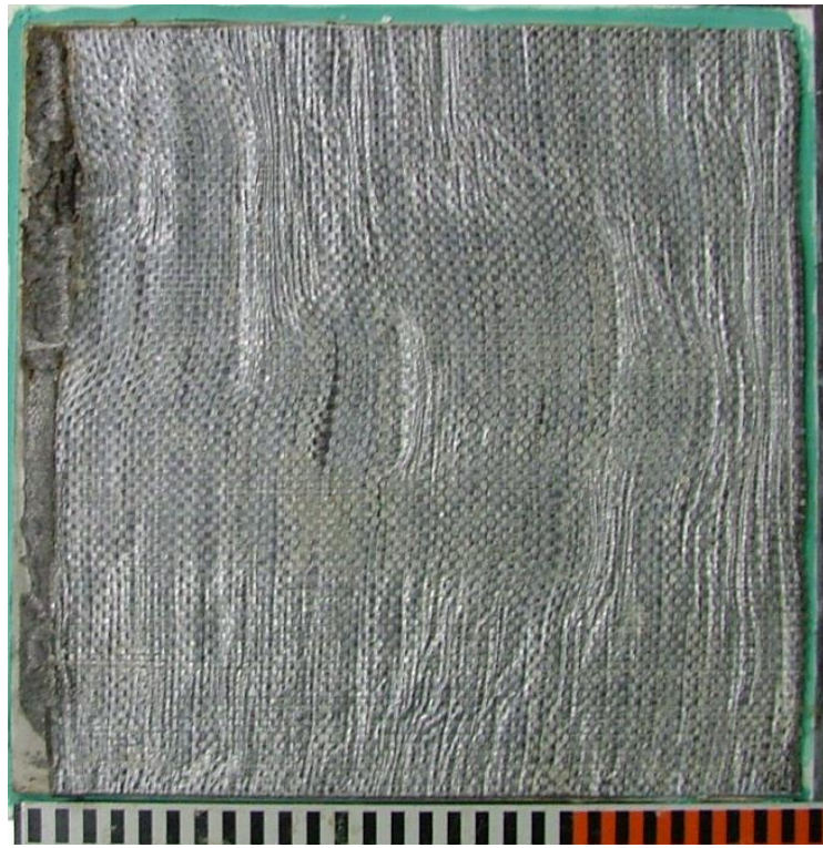
図 3-48 スケール影響試験後の供試体状況 ケース 2-6 (保護層表面)
