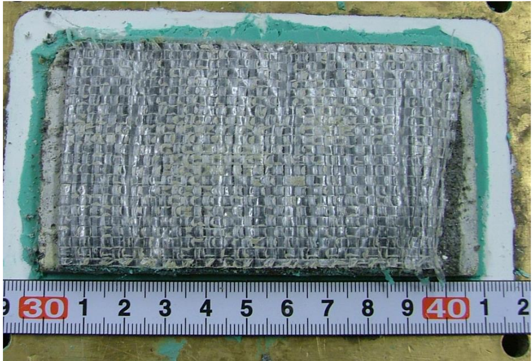
図 3-38 スケール影響試験後の供試体状況 ケース 2-1 (保護層表面)
