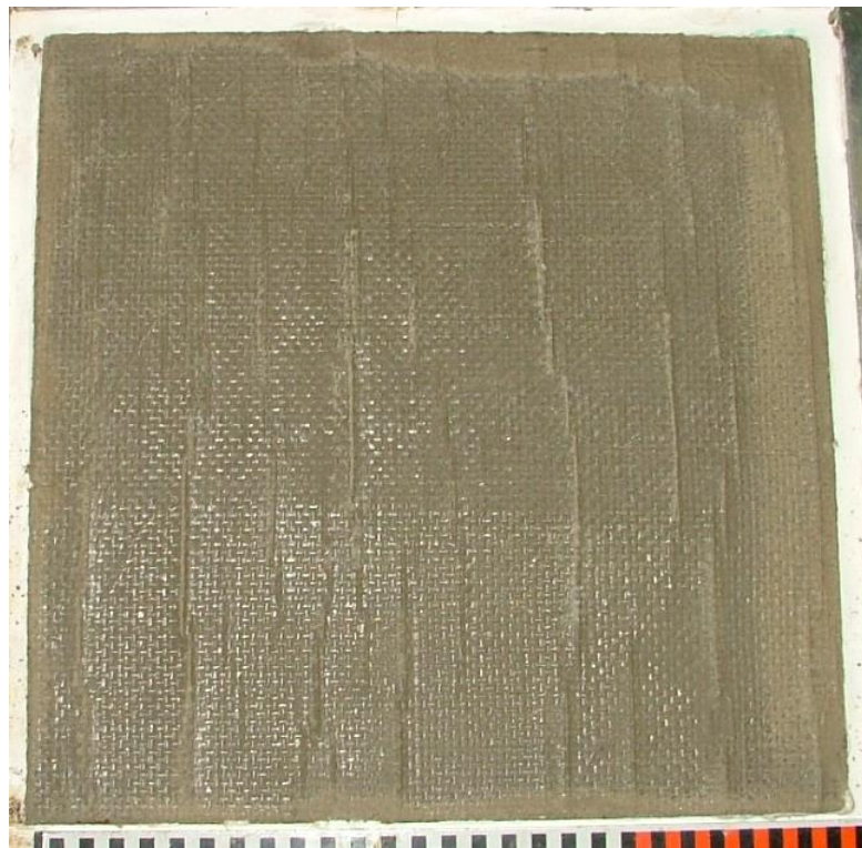
図 3-49 スケール影響試験後の供試体状況 ケース 2-6 (マンメイドロック表面)
