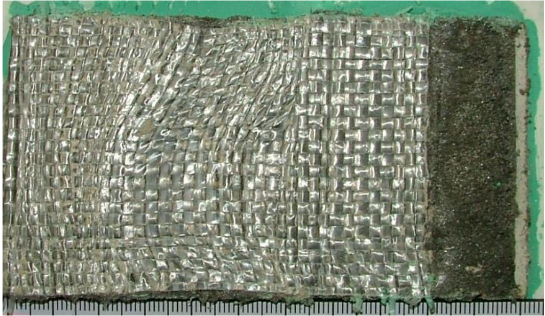
図 3-42 スケール影響試験後の供試体状況 ケース 2-3 (保護層表面)
