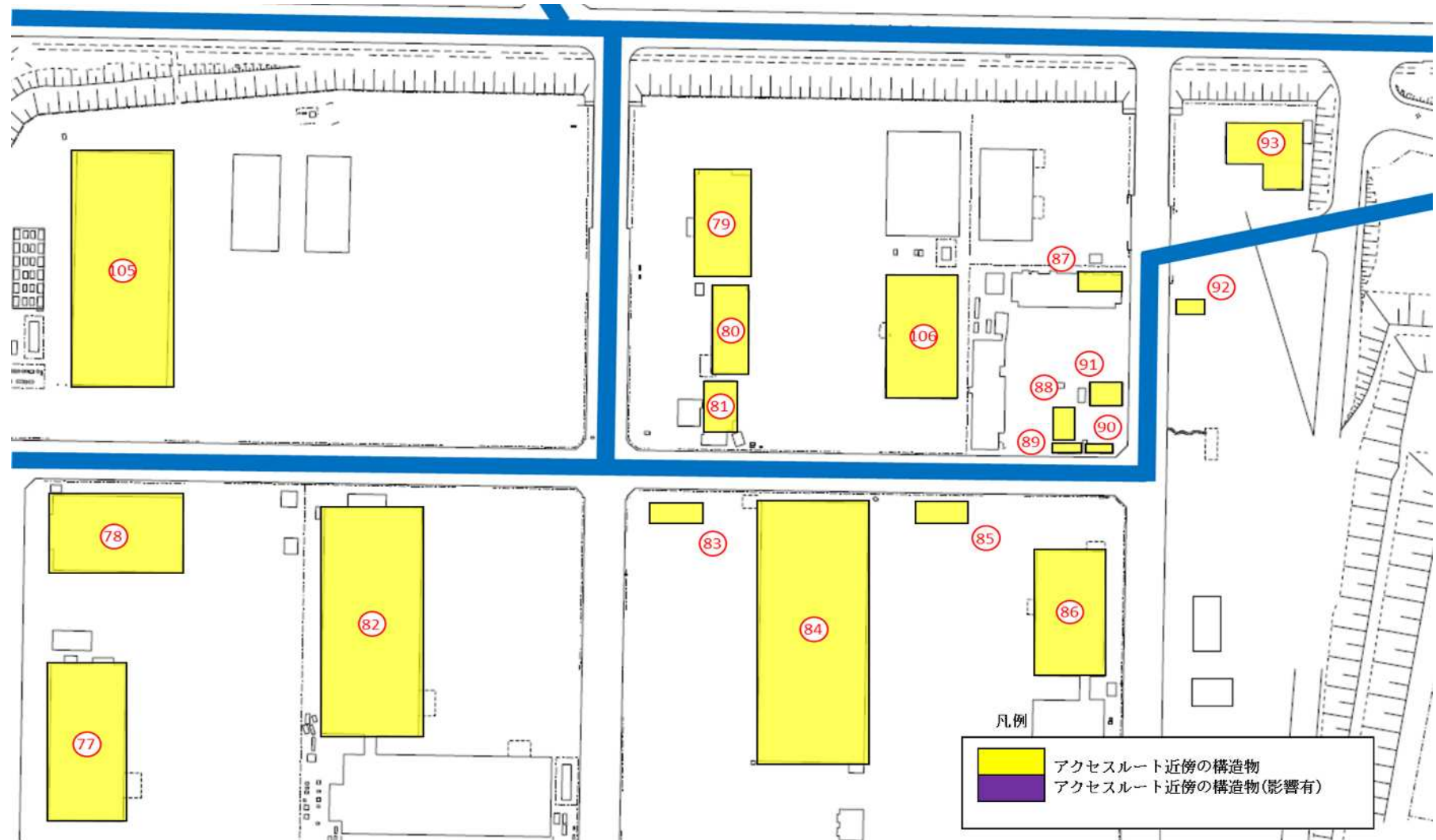
図 7-19 建屋倒壊時の屋外アクセラルトへの影響評価結果（企業棟詳細図）
