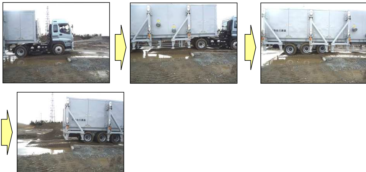
図 12-9 検証状況（約 20cm の段差）
