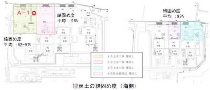
埋戻土の締固め度 (海側)
