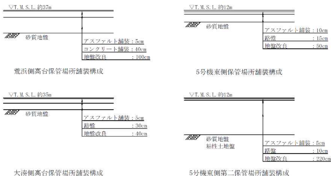
図 6-4 各保管場所の舗装構成
