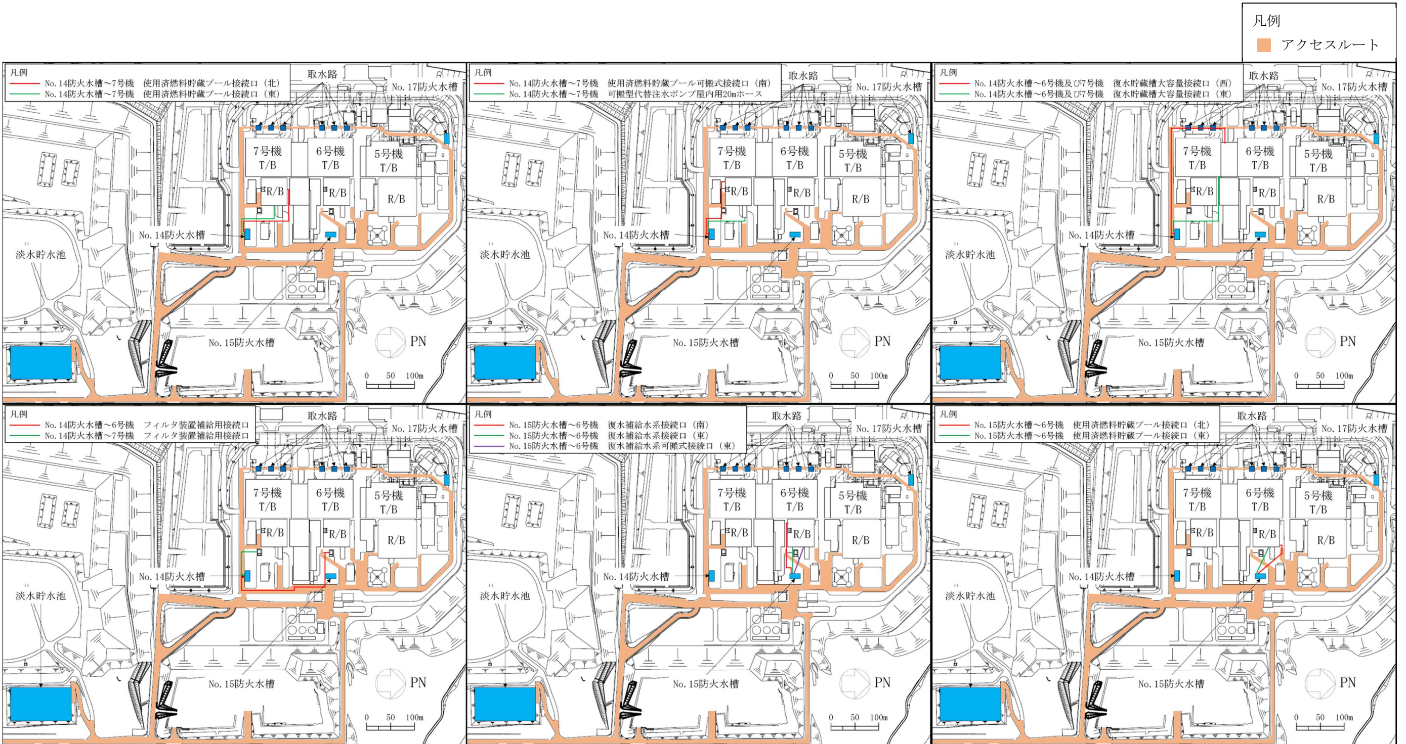
図 1-3 可搬型代替注水ポンプ屋外用 20m ホース 敷設ルート (3)
