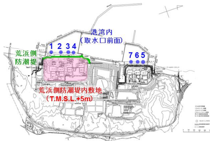
図 1.6-4 津波水位評価地点
