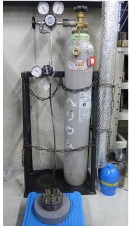
図 13 He 気密性確認試験状況
