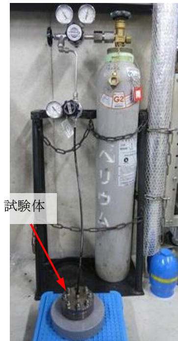
図5 He気密性確認試験状況
