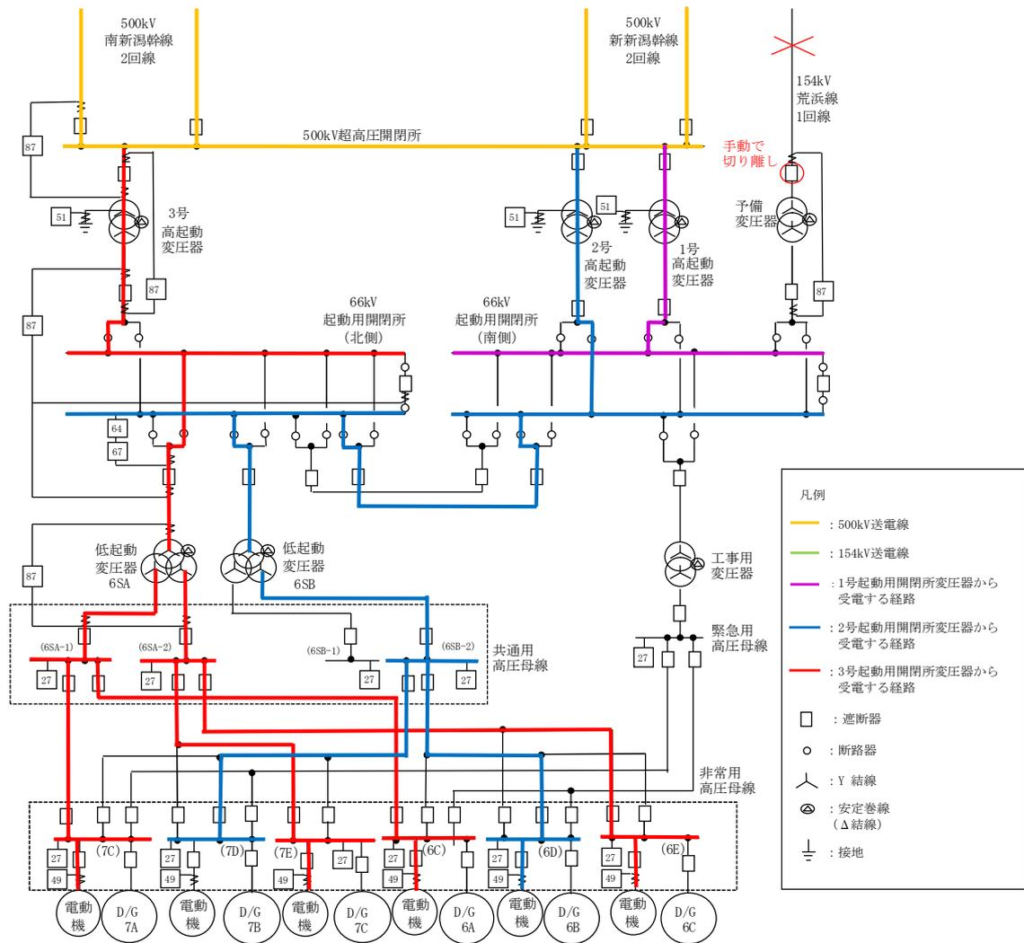
図1-15 故障箇所を隔離した状態
