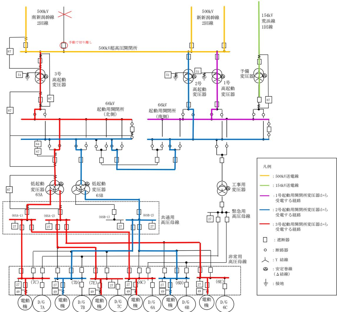
図1-12 故障箇所を隔離した状態
