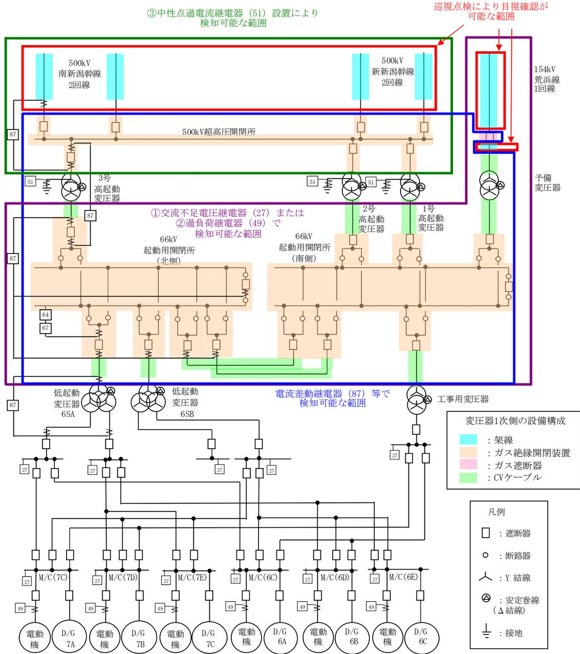
図1-9 完全地絡による電流差動継電器 (87) 等による検知部位
