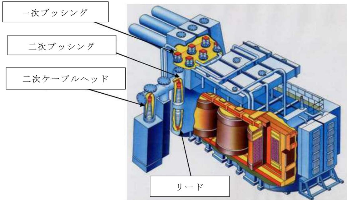
図1-27 変圧器構造概要（イメージ）
