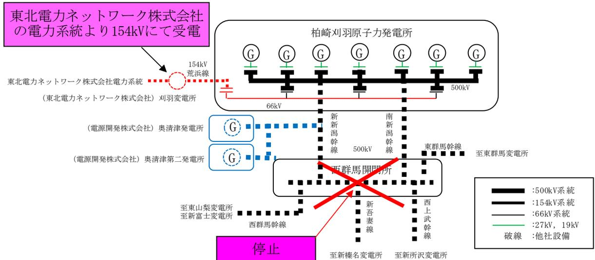
図2-2 西群馬開閉所全停時の供給系統
