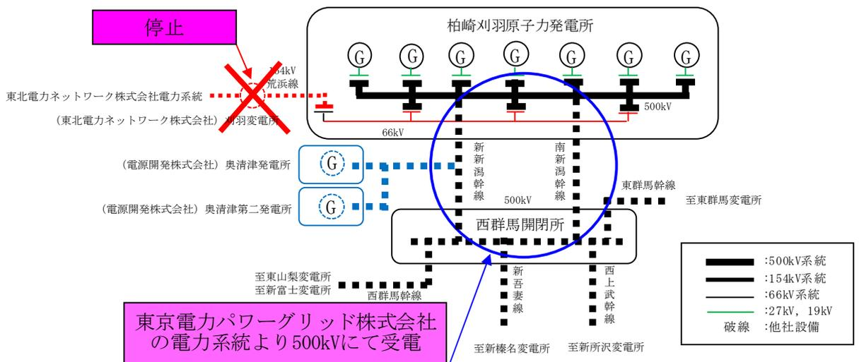
図2-3 刈羽変電所全停時の供給系統
