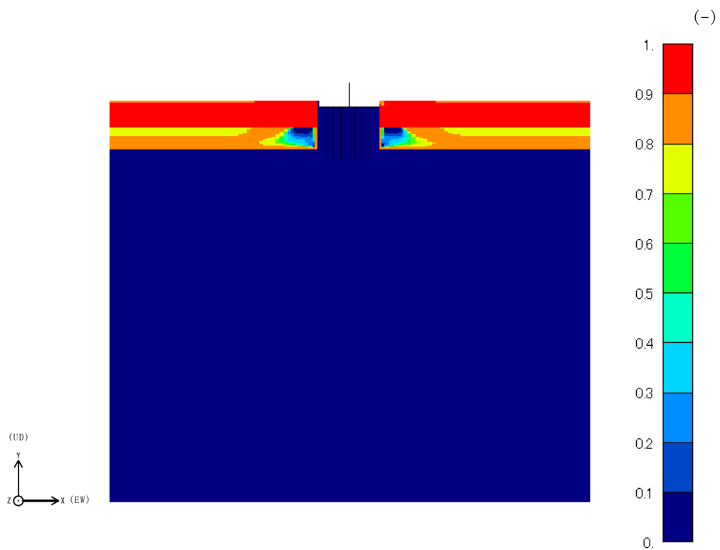
図 3-14 地盤の最大過剰間隙水圧比 (Ss-3, EW 方向)
