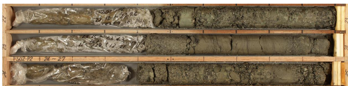
図 2-2 古安田層(A2s 層)の代表的なコア写真
