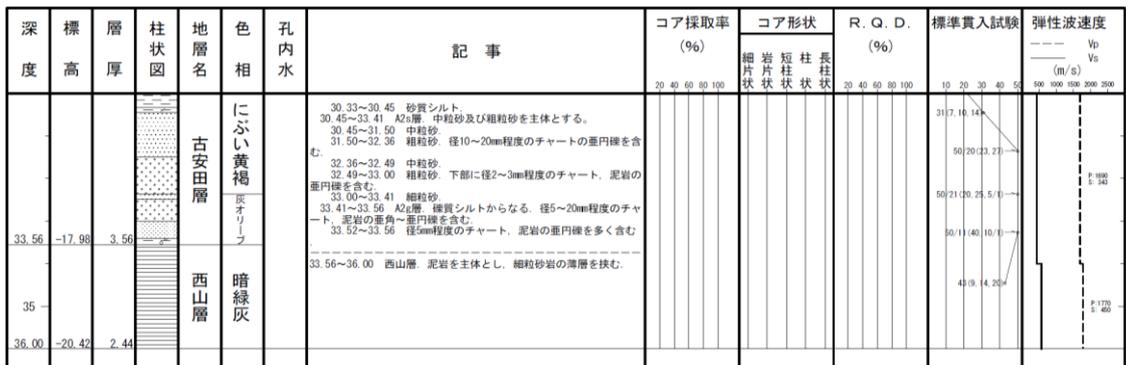
図 2-55(1) ボーリング柱状図 (GTG-P4)
