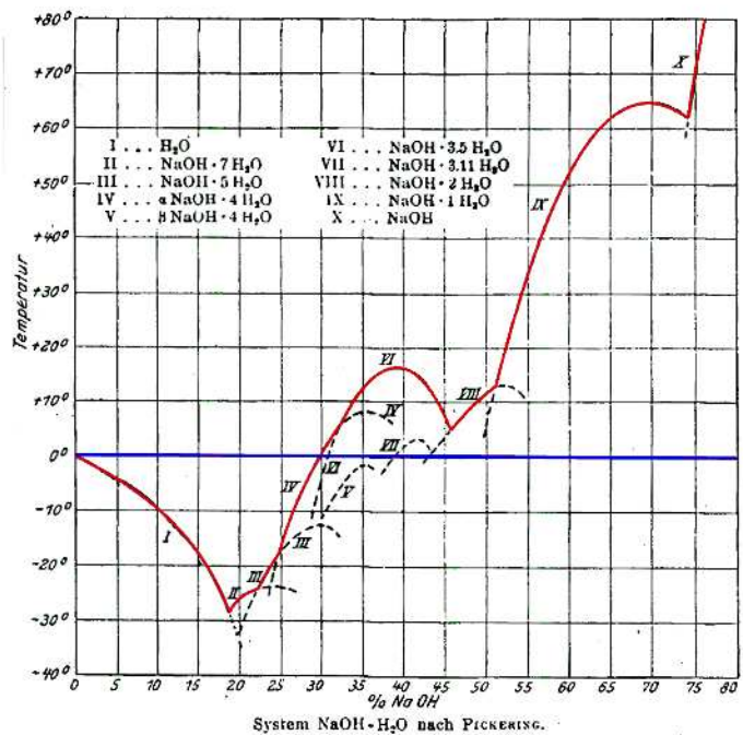
図4 水酸化ナトリウムの水系相平衡図
