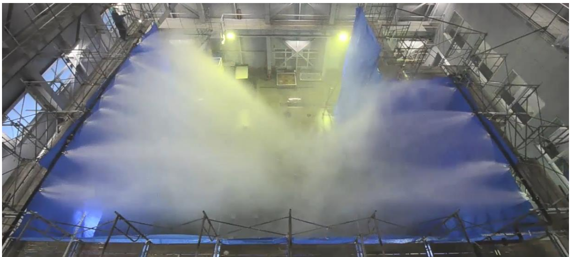
図1-7 スプレイ状態の試験状況（スプレイ量：132m 3 /h）
