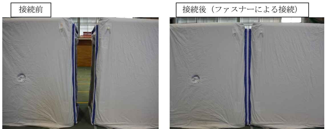
図 1.1-10 各エアートント間の接続 (イメージ)
