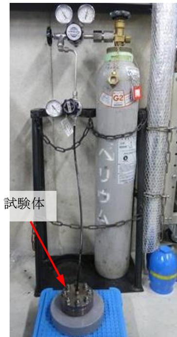
図5 He気密性確認試験状況
