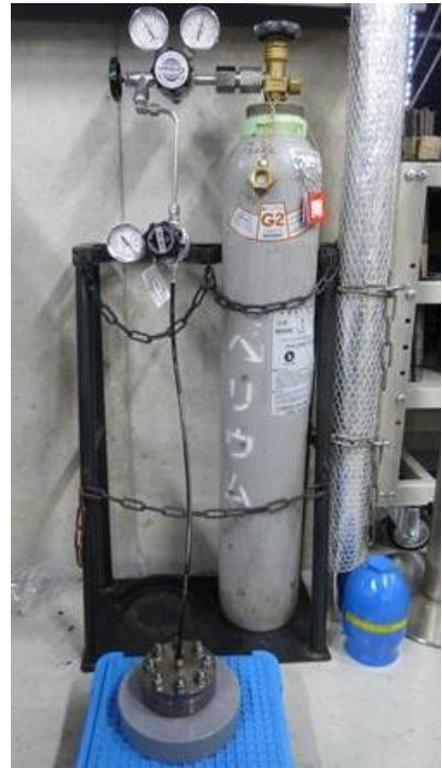
図 13 He 気密性確認試験状況
