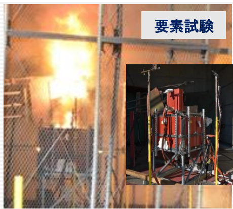
写真5 筐体を用いたHEAF試験
