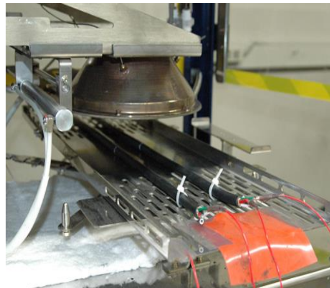
写真6 コーンカロリメータによるケーブル熱劣化試験の一例
