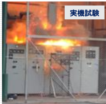
写真4 電源盤を用いたHEAF試験
