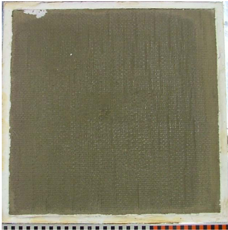
図 3-45 スケール影響試験後の供試体状況 ケース 2-4 (マンメイドロック表面)
