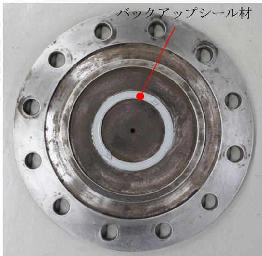
図7 バックアップシール材塗布状況
