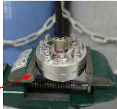
図5 気密性確認試験状況
