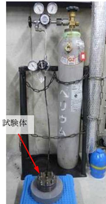
図5 He気密性確認試験状況
