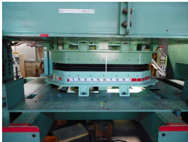
(c) 矩形供試体の設置状況
