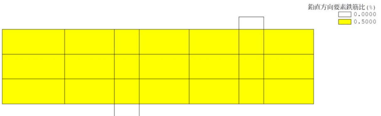
図 5-43 要素鉄筋比 (鉛直方向)
