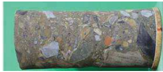
試験後の供試体
