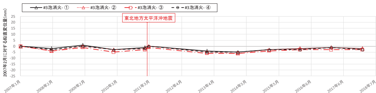
図 2-15 3号機泡消火設備基礎の鉛直変位 (2007年2月に対する鉛直変位量)
