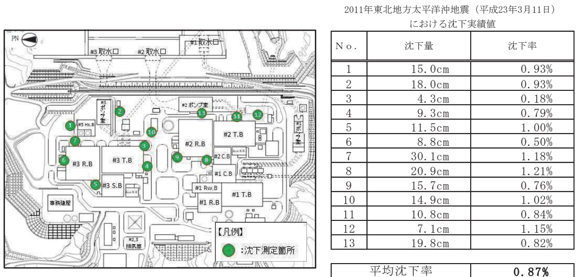
図 2-3 2011年東北地方太平洋沖地震における女川原子力発電所の沈下実績
