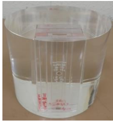
校正用簡易頸部ファントム (PMMA製13cmΦ × 12cm)
