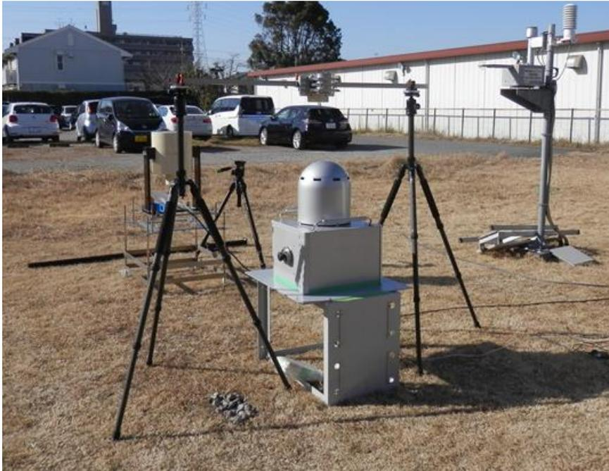
図 12 本研究で開発した照射装置による校正風景
