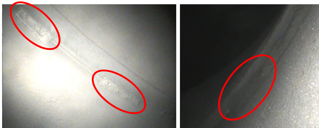
給水内管裏当金部点検結果 (B - S G の例)
