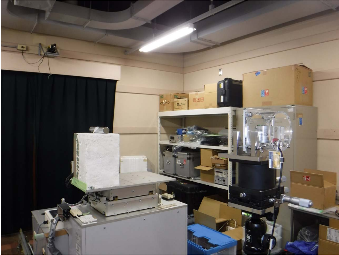
図 15 コリメート照射装置を用いた校正風景。レーザー距離計を用いてより精度の高い位置合わせが可能となっている。
