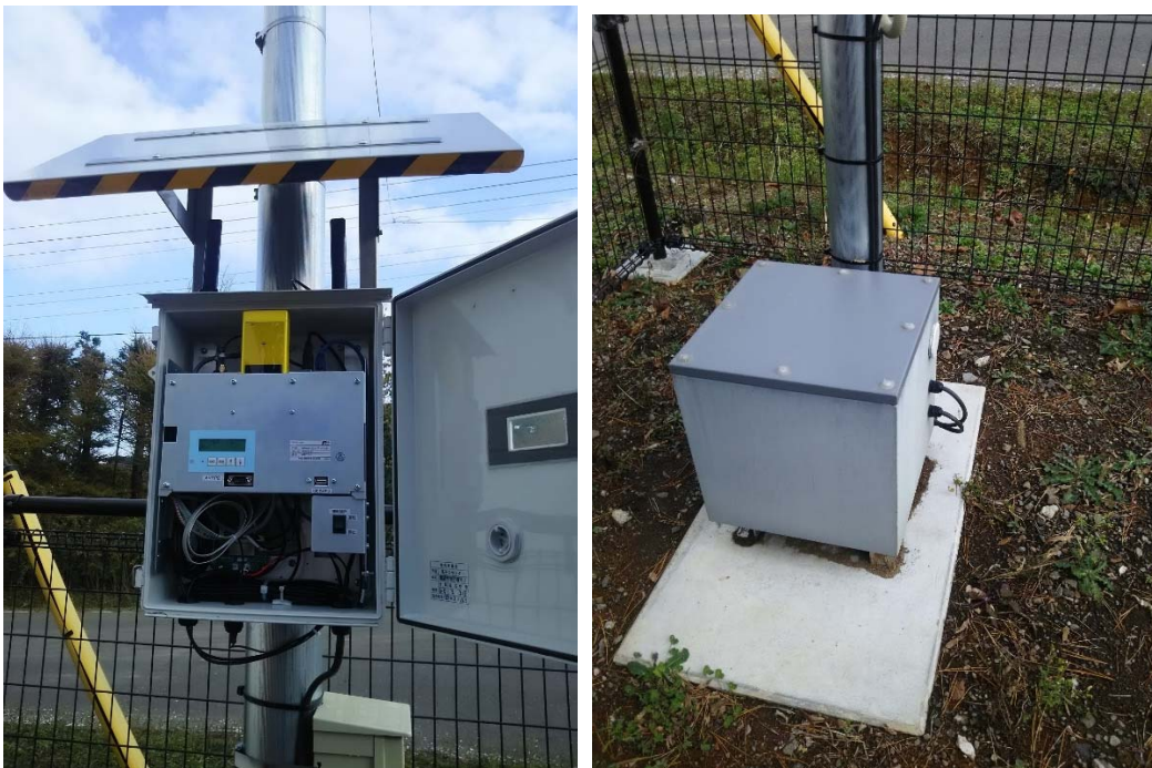
図2 半導体式線量計の設置状況 上部に雪よけの屋根、下部には停電時用のバッテリーが配置されている
