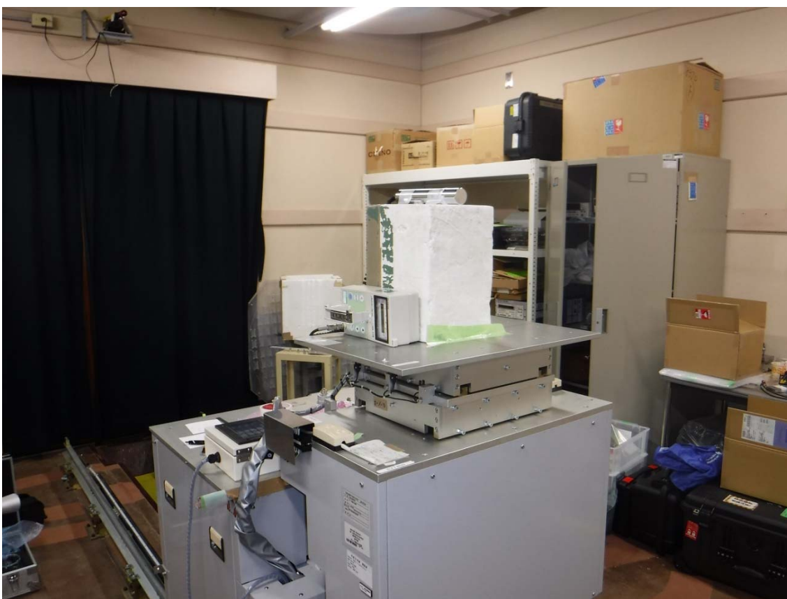
図 13 従来照射場でのサーベイメータの校正風景。設置台からの散乱線を低減させるために、発砲スチロール上に検出器を設置している。
