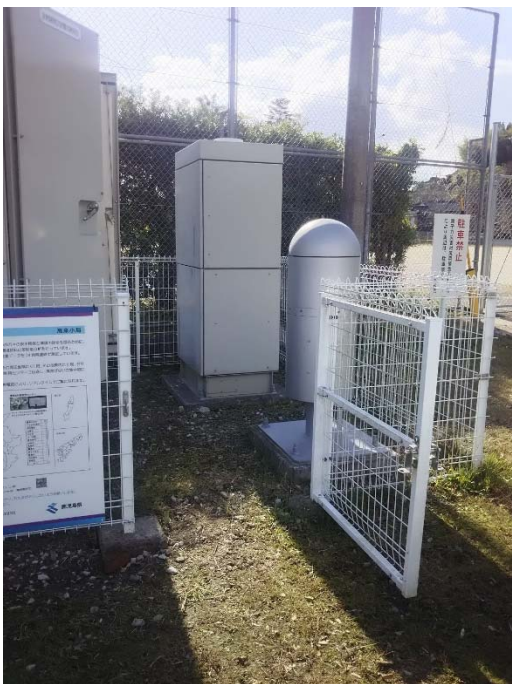
図7 鹿児島県における地上設置タイプの配置例 検出器は電離箱
