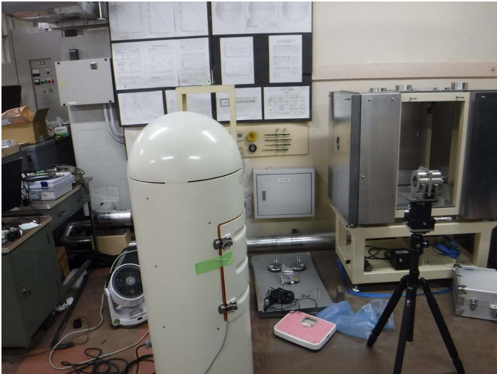
図 17 距離 100 cm におけるコリメート照射装置での校正風景
