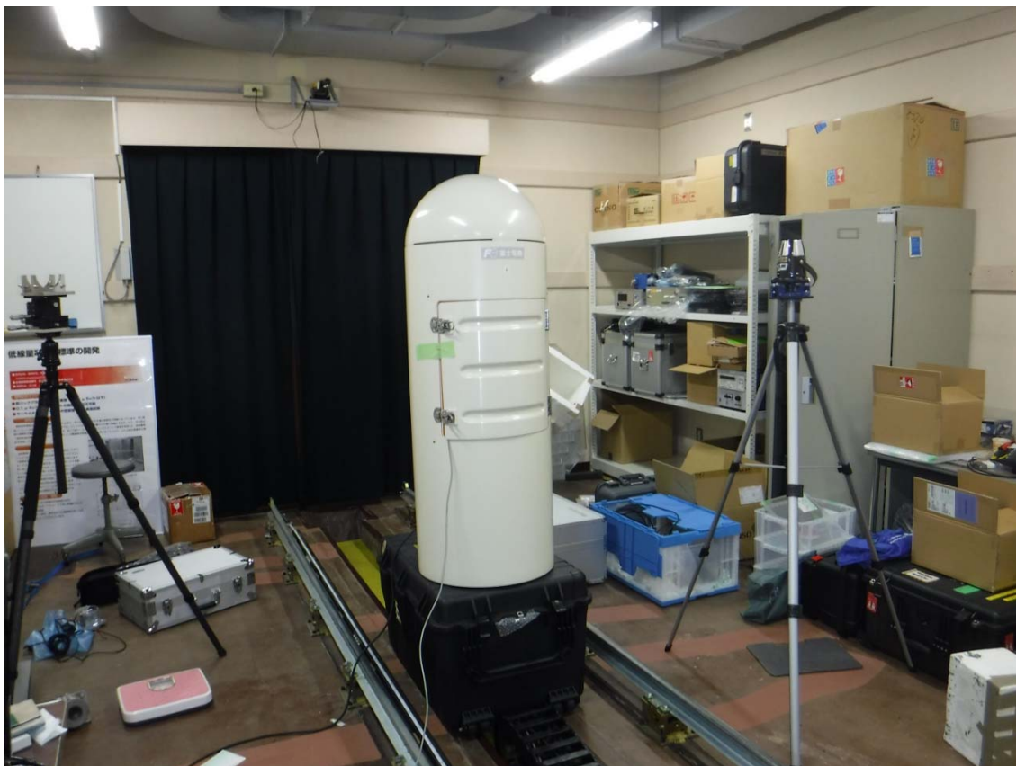
図16 半導体検出器モニタリング線量計の設置風景。従来照射場では、床面より150 cmの位置が照射高さとなっている。RS232Cを用いてPCと通信し、測定結果を収集している。
