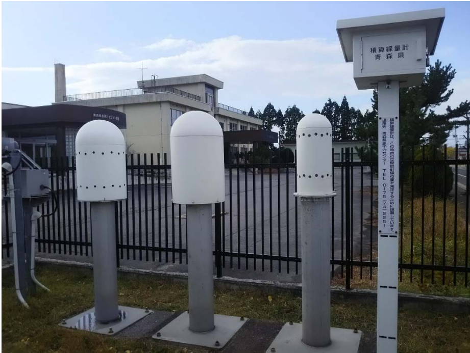
図1 青森県における、電離箱、NaI(Tl)シンチレーション、半導体、積算型線量計の4種類が設置されている局
