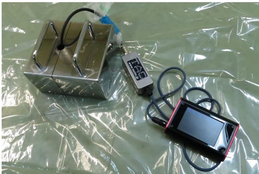
図3-2 製作した小型遮蔽体(鉛厚さ4.5 cm)
