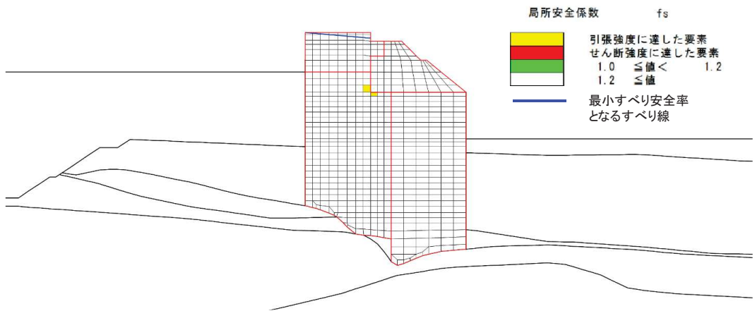
図 5-44 背面補強工の最小すべり安全率時刻における局所安全係数分布 (断面②, S d - D 2 (-+), t=16.36s)
