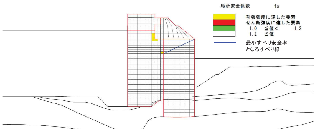
図 5-18 置換コンクリートの局所安全係数分布（断面①）
