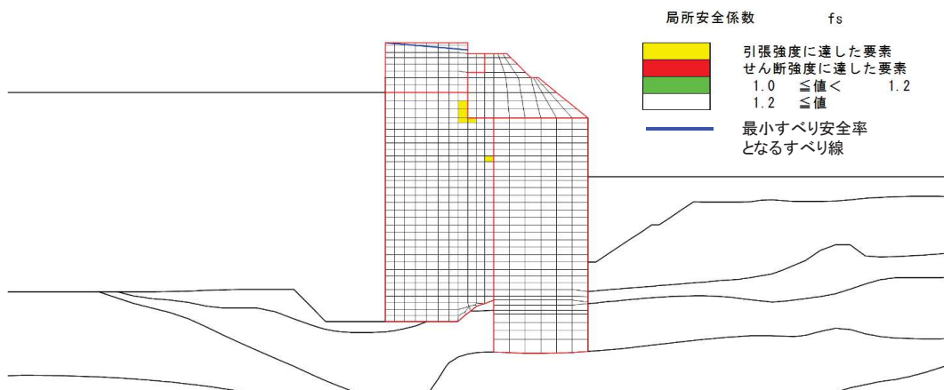
図 5-13 背面補強工の局所安全係数分布 (断面①)
