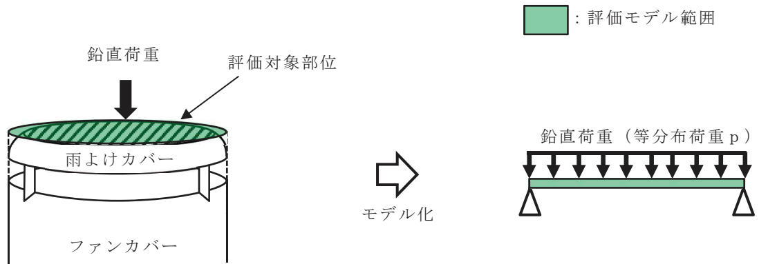
図 3-5 雨よけカバーのモデル図
