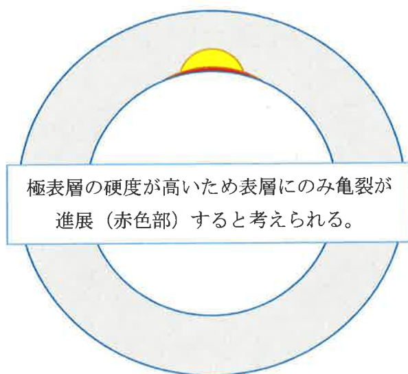
図－3 極表層硬さによる円周方向亀裂進展の模式図
