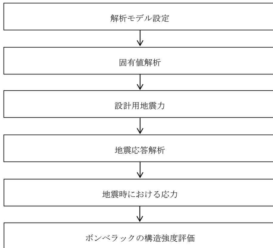
図 2-1 ボンベラックの耐震評価フロー
