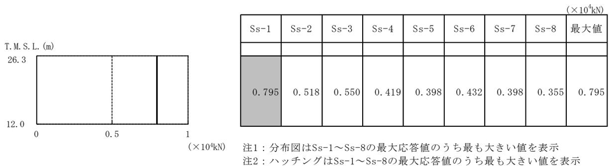
図4-12 最大応答軸力 (基準地震動 S<sub>s</sub>, 鉛直方向)
