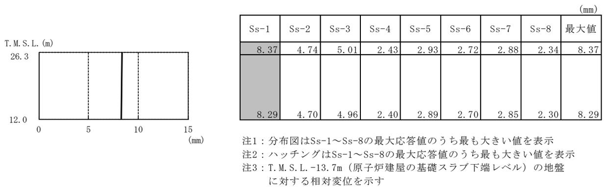
図4-11 最大応答変位 (基準地震動 S<sub>s</sub>, 鉛直方向)
