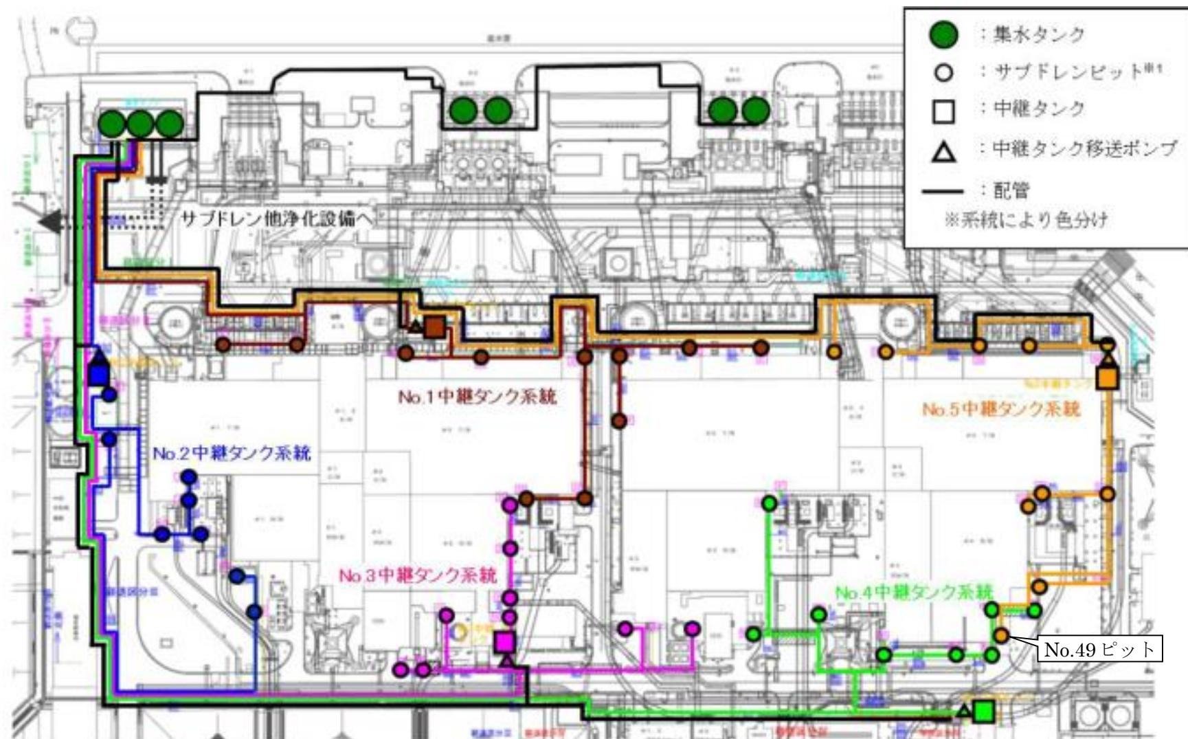
※1 排水ポンプおよび水位計は、サブドレンピット内部に設置されている。（排水ポンプ：各ピットに1台ずつ、計46台、水位計：各ピットに2台ずつ、計92台）
