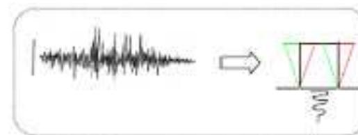
基準地震動  $S_s$  を策定し、下記の施設等の耐震安全性評価を実施。
