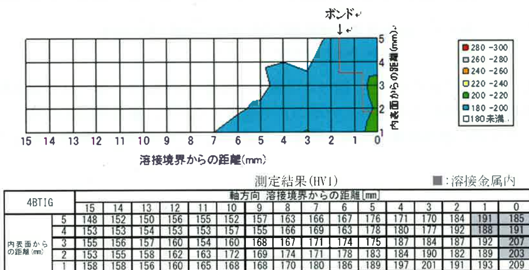
図-4 4B配管 TIG溶接 板厚内部硬さ測定結果
