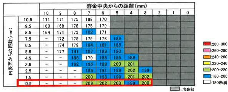
図-3 4B 配管 TIG+SMAW 溶接 板厚内部硬さ測定結果 (荷重 1 kg)
