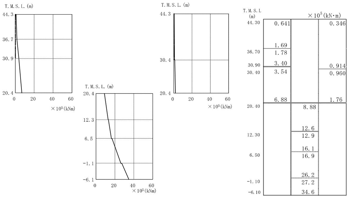
図 4-5 最大応答曲げモーメント (NS 方向)
