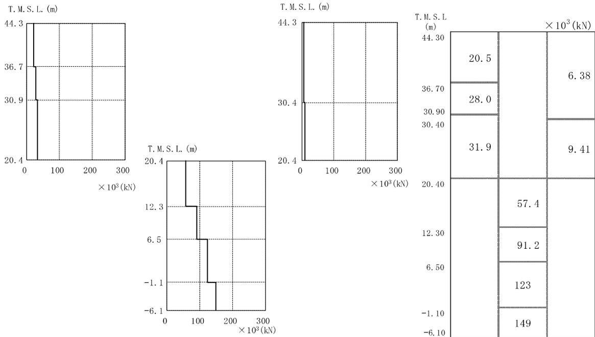
図 4-4 最大応答せん断力 (NS 方向)
