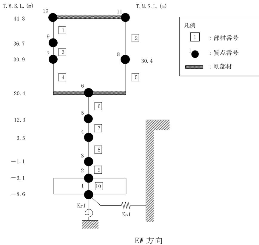
図 3-5 地震応答解析モデル (水平方向)
