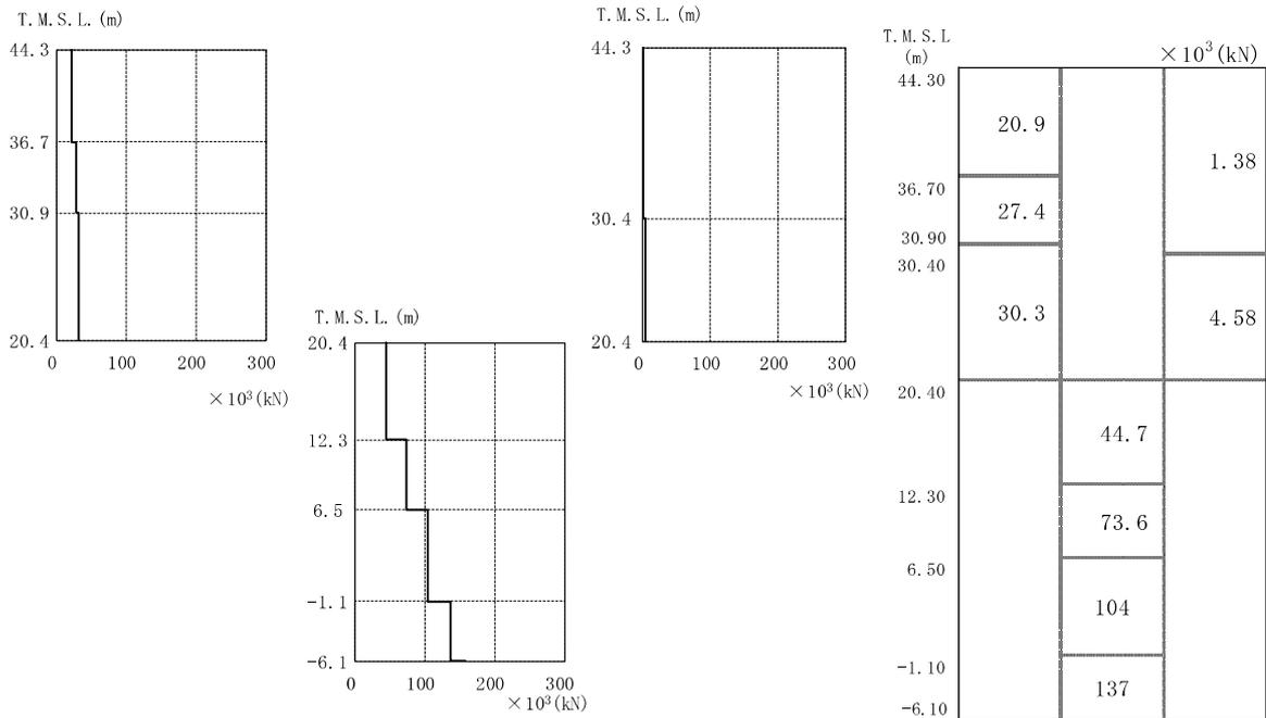
図 4-8 最大応答せん断力 (EW 方向)
