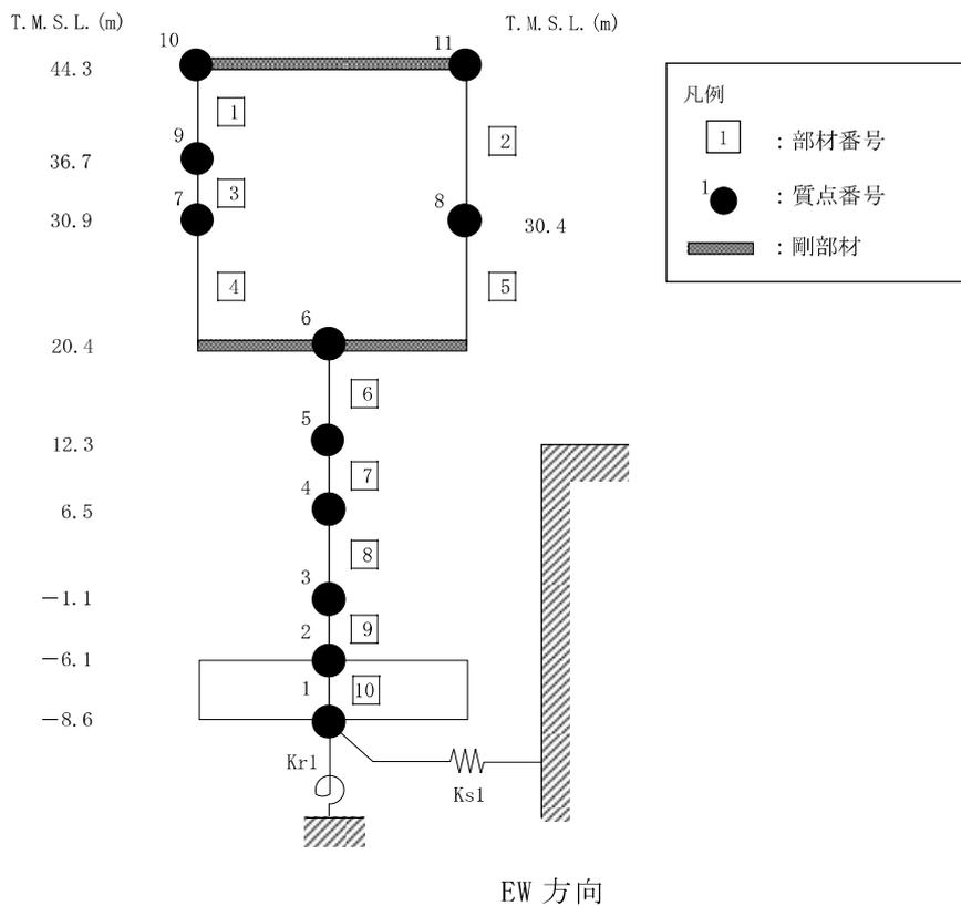
図 3-3 地震応答解析モデル（水平方向）
