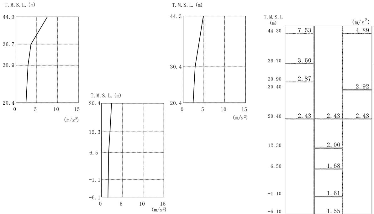
図 4-2 最大応答加速度 (NS 方向)
