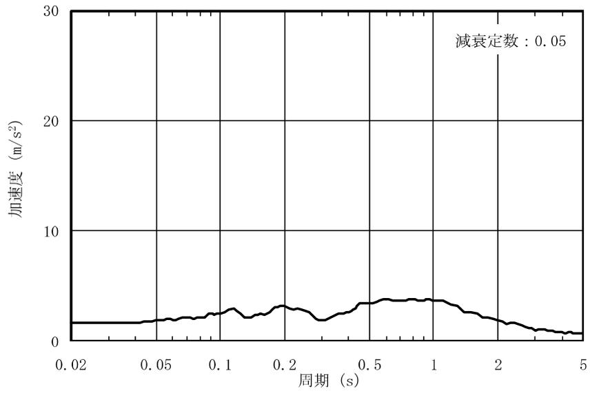
図 3-5 入力動の加速度応答スペクトル (水平方向)
