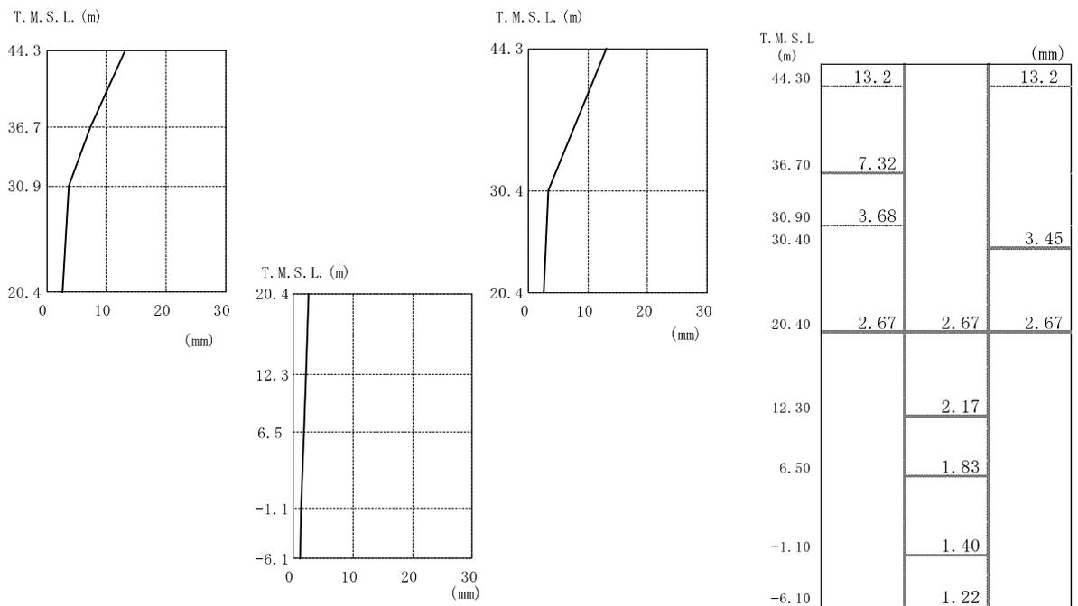
図 4-7 最大応答変位 (EW 方向)
