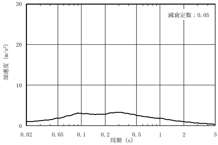
図 3-8 入力地震動の加速度応答スペクトル
