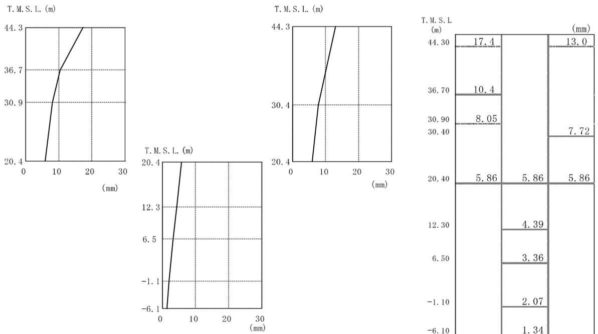
図 4-3 最大応答変位 (NS 方向)
