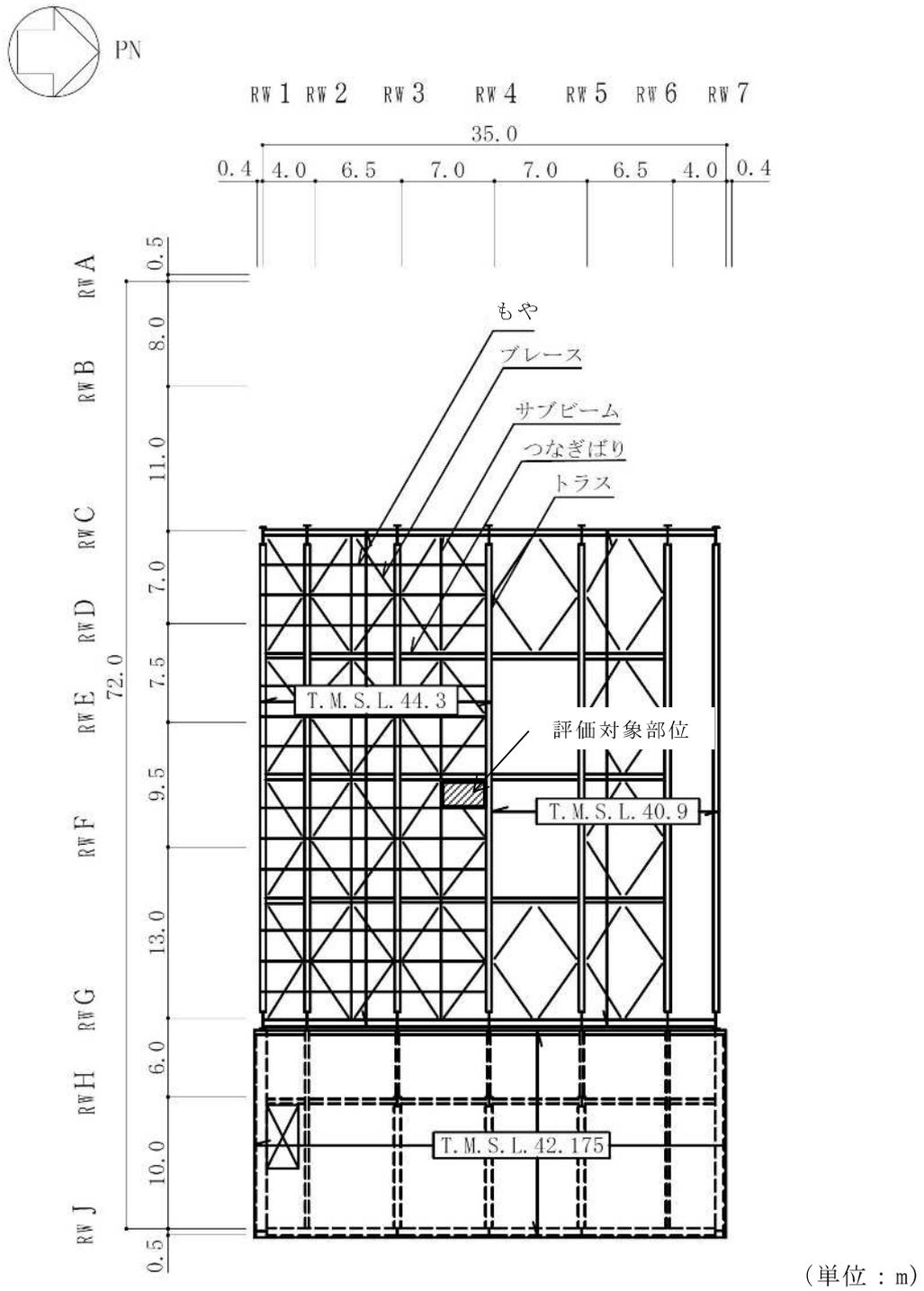
図 3-1 屋根スラブの評価対象部位 (T.M.S.L. 44.3m)
