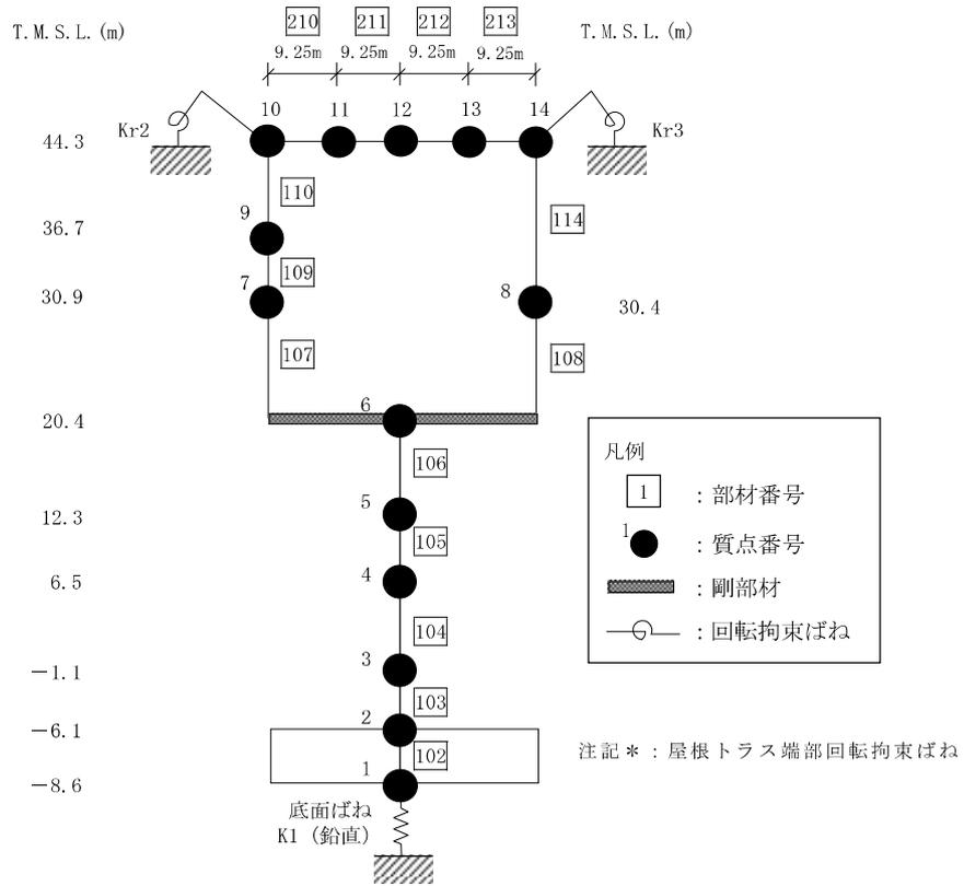
図 3-6 地震応答解析モデル (鉛直方向)
