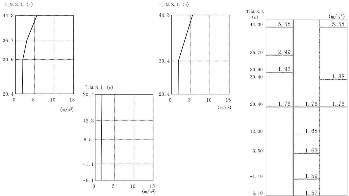
図 4-6 最大応答加速度 (EW 方向)
