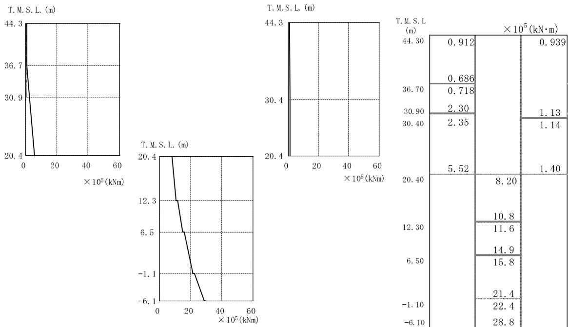
図 4-9 最大応答曲げモーメント (EW 方向)
