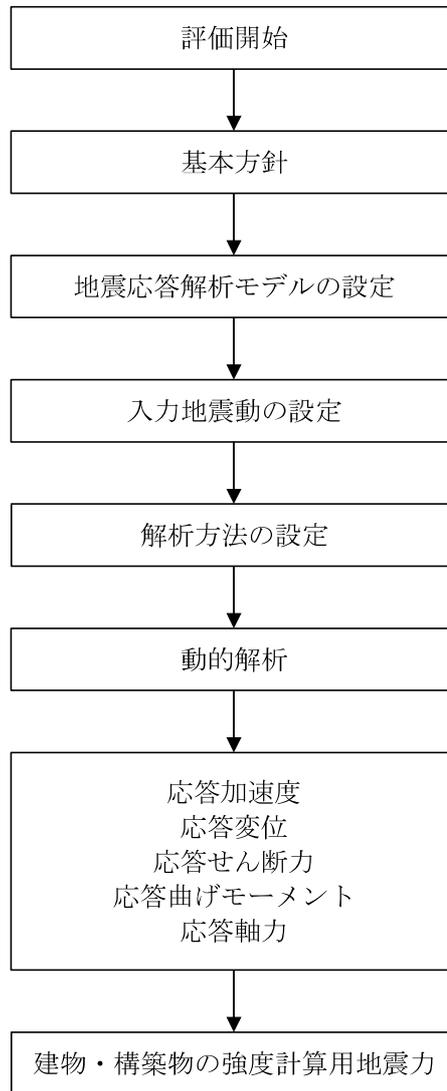
図 2-4 廃棄物処理建屋の地震応答解析フロー
