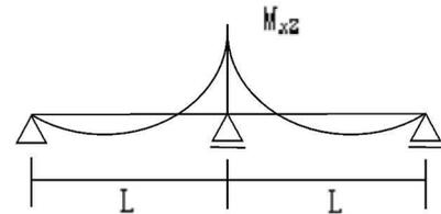
図3-2 屋根スラブの評価モデル
