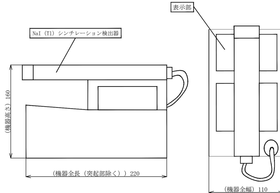
注記\*：発電所及びその周辺（発電所の周辺海域を含む。）のうち、任意の場所でのモニタリング時に使用する。
