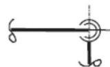
立ち上がり管に取り付く場合 (レジューサの上方が小径端側 のとき)
