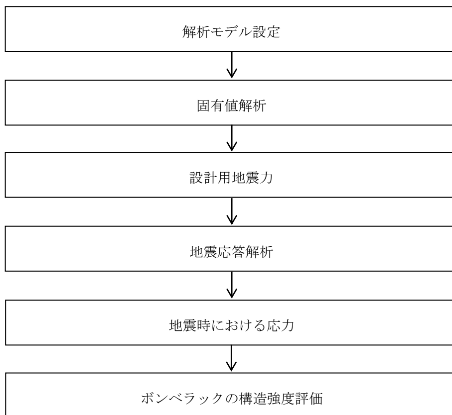
図 2-1 ボンベラックの耐震評価フロー
