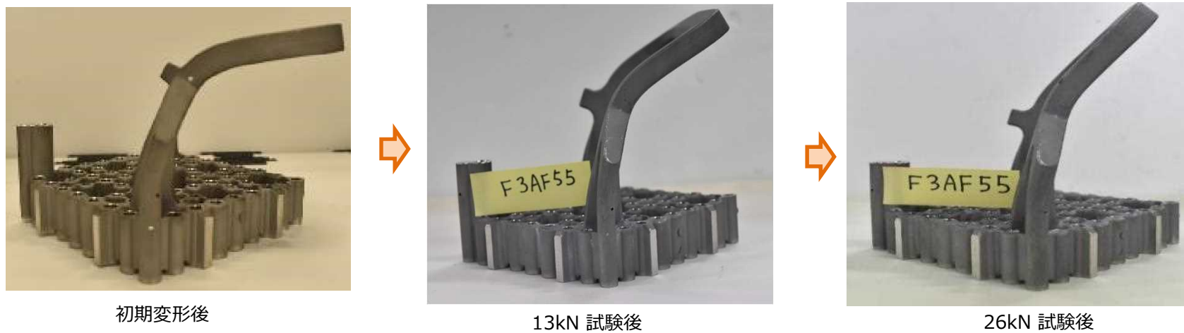
燃料ハンドル (上部タイププレート) の引っ張り試験後の状況
