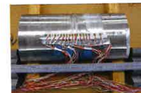
図 3 残留応力測定状況例
