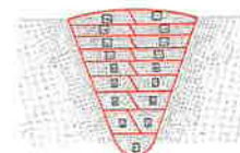
(b) 溶接積層図の例（一般配管：8B-TIG）
