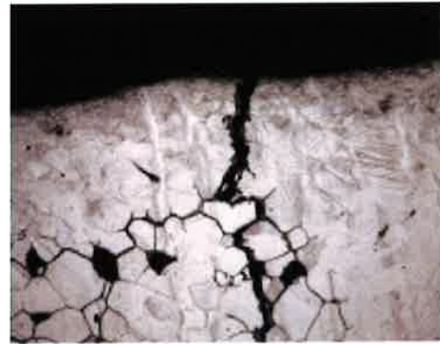
図7 2F-3 シュラウド H6a ボートサンプル断面観察写真
