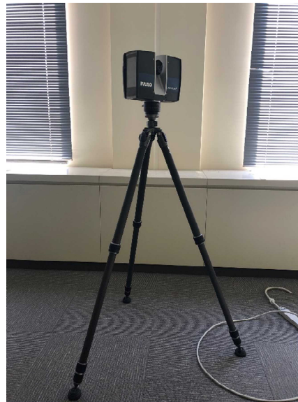
スキャナ ※三脚に設置した状態
