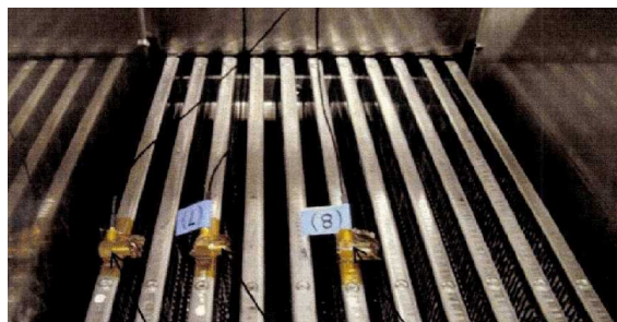
図2 触媒カートリッジの収納状態
