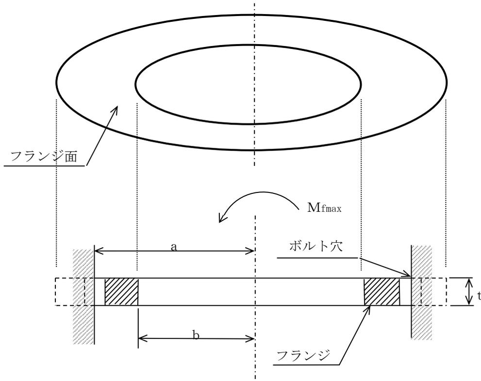
図 4-6 フランジ断面の計算モデル
