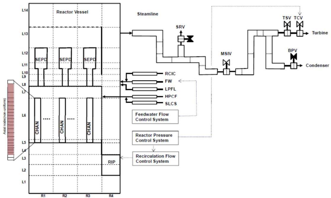
図1 TRACEコードABWRプラントのノード分割(例)
