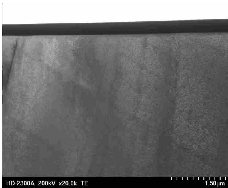
図 3.2.1-62(3) 引張試験後の変形組織(TP2) A237(SUS316L、HT 材、 1.01 \times 10^{25} \text{ n/m}^2 (E > 1 \text{ MeV}) )
