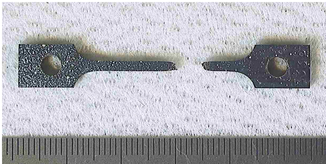
図 3.2.1-16 引張試験後の試験片外観写真 E332(SUS316L、AR 材、 1.49 \times 10^{25} \text{ n/m}^2 (E > 1 \text{ MeV}) )
