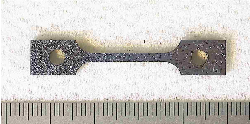
図 3.2.1-14 引張試験前の試験片外観写真 E332(SUS316L、AR 材、 1.49 \times 10^{25} \text{ n/m}^2 (E > 1 \text{ MeV}) )
