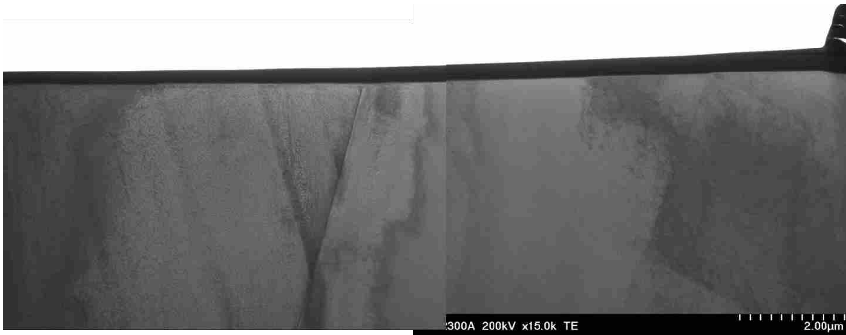
図 3.2.1-62(1) 引張試験後の変形組織(TP2) A237(SUS316L、HT 材、 1.01 \times 10^{25} \text{ n/m}^2 ( E > 1 \text{ MeV} ))
