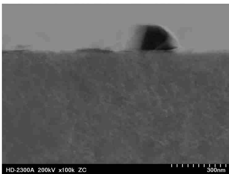
図 3.2.1-71(2) TP2 におけるマイクロ組織 64HC405(SUS316L(HAZ)、 5.16 \times 10^{24} \text{ n/m}^2 (E > 1 \text{ MeV}) )
