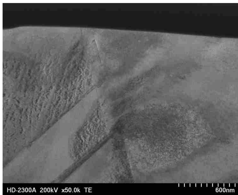
図 3.2.1-40(5) 引張試験後の変形組織(TP1) E331(SUS316L、AR 材、 1.65 \times 10^{25} \text{ n/m}^2 ( E > 1 \text{ MeV} ))
