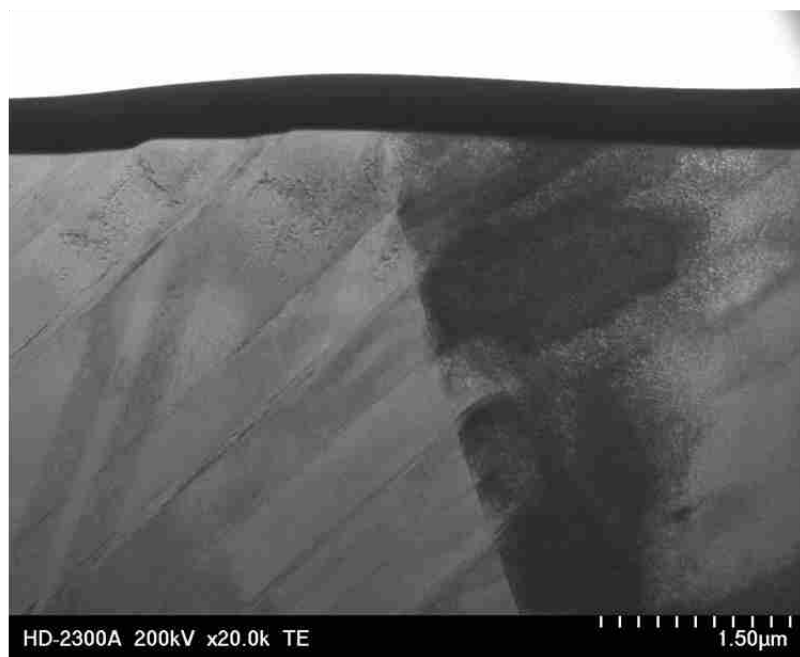
図 3.2.1-40(4) 引張試験後の変形組織(TP1) E331(SUS316L、AR 材、 1.65 \times 10^{25} \text{ n/m}^2 ( E > 1 \text{ MeV} ))
