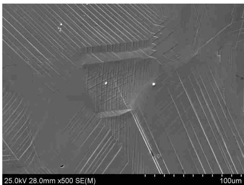
図 3.2.1-30(4) 引張試験後の SEM 写真 E331(SUS316L、AR 材、 1.65 \times 10^{25} \text{ n/m}^2 (E > 1 \text{ MeV}) )
