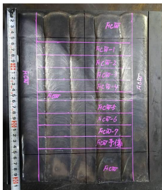
(b) 予亀裂導入後クラッド溶接
