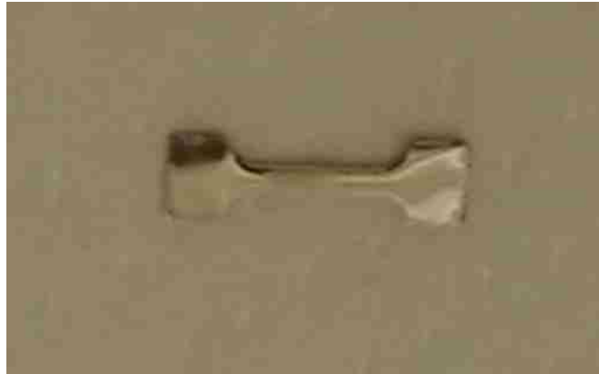
図 3.2.1-49 微小試験片外観写真 A237(SUS316L、HT 材、 1.01 \times 10^{25} \text{ n/m}^2 (E > 1 \text{ MeV}) )
