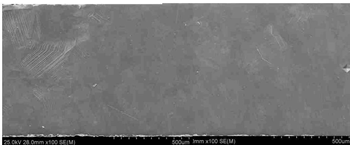
図 3.2.1-30(1) 引張試験後の SEM 写真 E331(SUS316L、AR 材、 1.65 \times 10^{25} \text{ n/m}^2 (E > 1 \text{ MeV}) )
