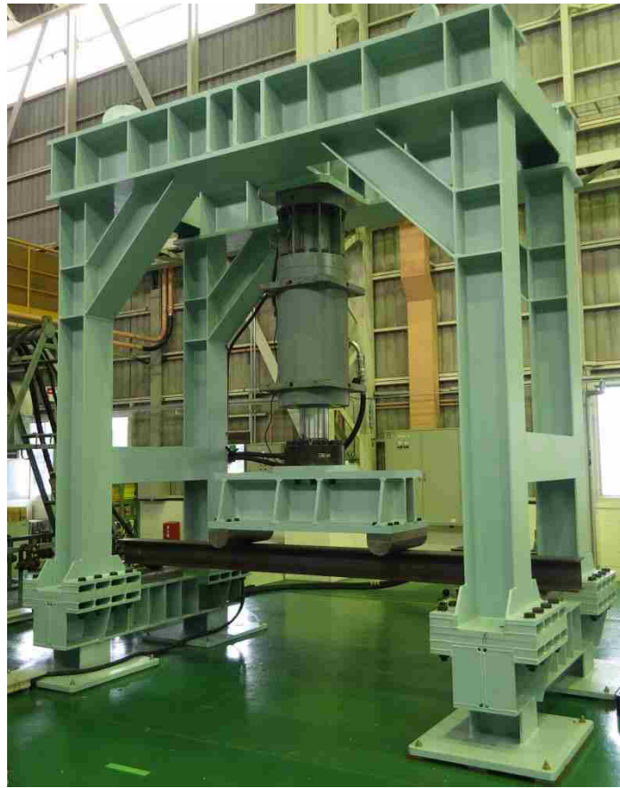
図 3.1.4.3-56 アクチュエータ、反力フレーム及び治具
