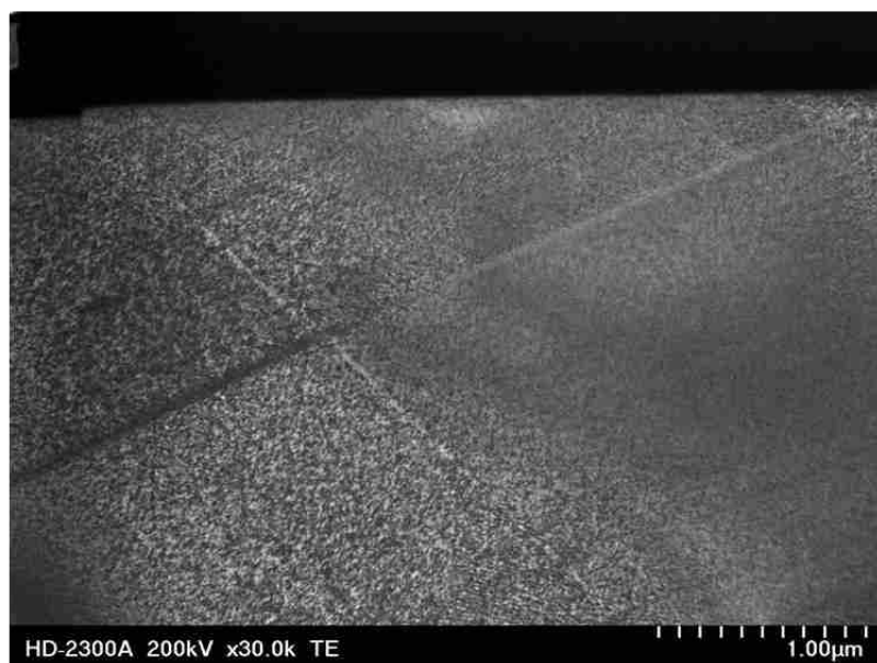
図 3.2.1-40(2) 引張試験後の変形組織(TP2) E331(SUS316L、AR 材、 1.65 \times 10^{25} \text{ n/m}^2 ( E > 1 \text{ MeV} ))
