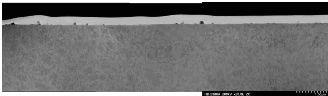
図 3.2.1-71(1) TP2 におけるマイクロ組織 64HC405(SUS316L(HAZ)、 5.16 \times 10^{24} \text{ n/m}^2 (E > 1 \text{ MeV}) )
