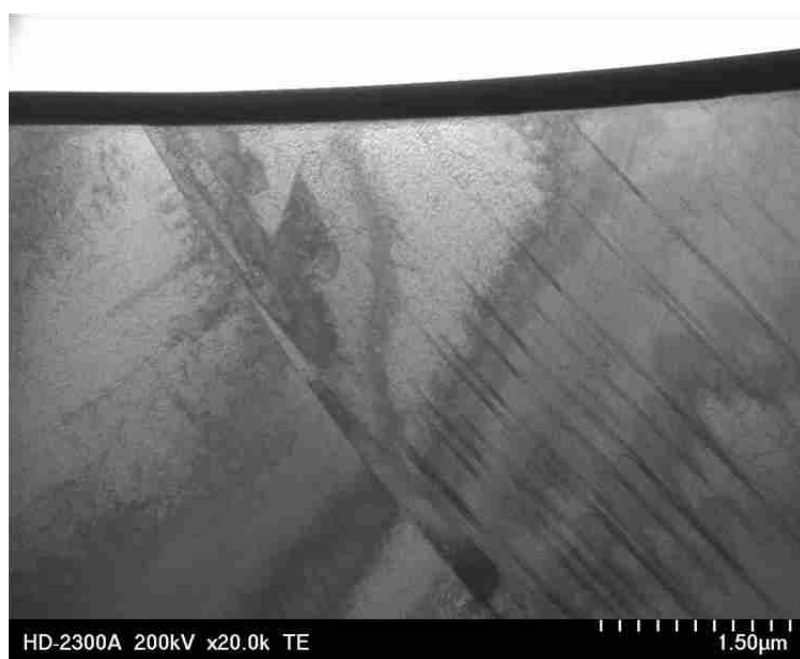
図 3.2.1-61(3) 引張試験後の変形組織(TP1) A237(SUS316L、HT 材、 1.01 \times 10^{25} \text{ n/m}^2 ( E > 1 \text{ MeV} ))
