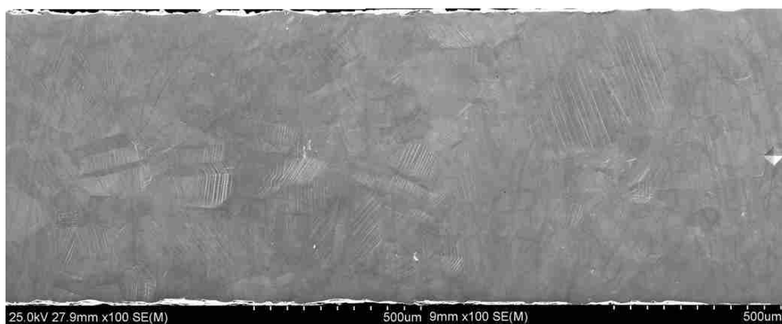
図 3.2.1-51(1) 引張試験後の SEM 写真 A237(SUS316L、HT 材、 1.01 \times 10^{25} \text{ n/m}^2 (E > 1 \text{ MeV}) )
