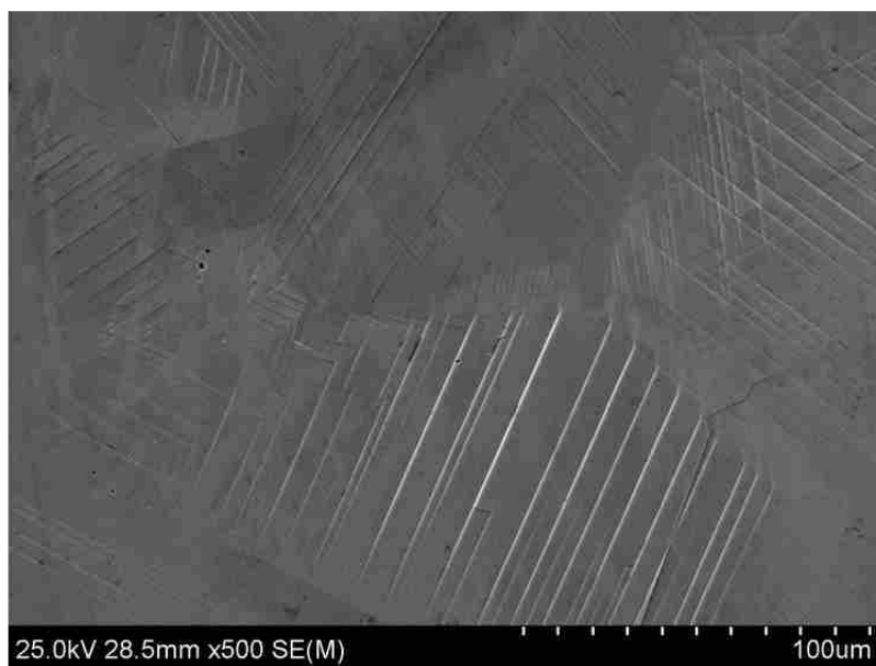
図 3.2.1-51(3) 引張試験後の SEM 写真 A237(SUS316L、HT 材、 1.01 \times 10^{25} \text{ n/m}^2 (E > 1 \text{ MeV}) )
