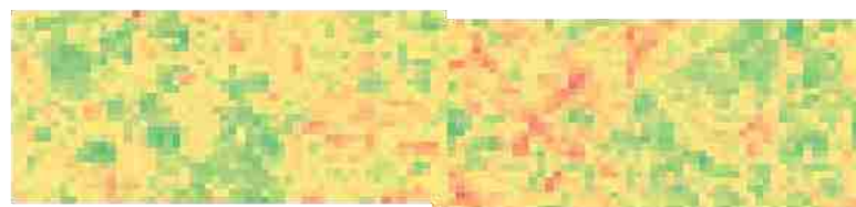
図 3.2.1-59 引張試験後における変形部の EBSD 測定結果 A237(SUS316L、HT 材、 1.01 \times 10^{25} \text{ n/m}^2 (E > 1 \text{ MeV}) )
