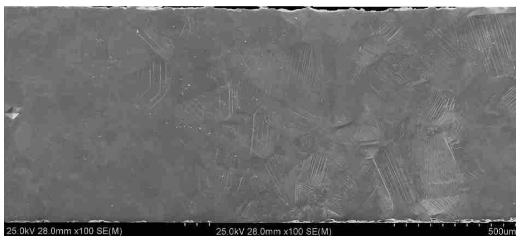
図 3.2.1-30(2) 引張試験後の SEM 写真 E331(SUS316L、AR 材、 1.65 \times 10^{25} \text{ n/m}^2 (E > 1 \text{ MeV}) )
