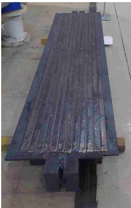
図 3.1.4.1-5 クラッド溶接後の外観写真
