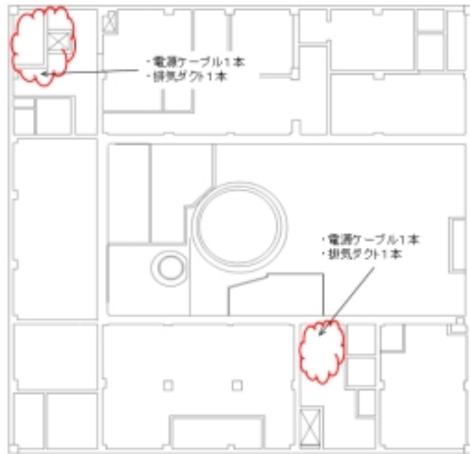
第 1.3 図 電源ケーブル、排気ダクトの 保管場所（原子炉建家 1階）
