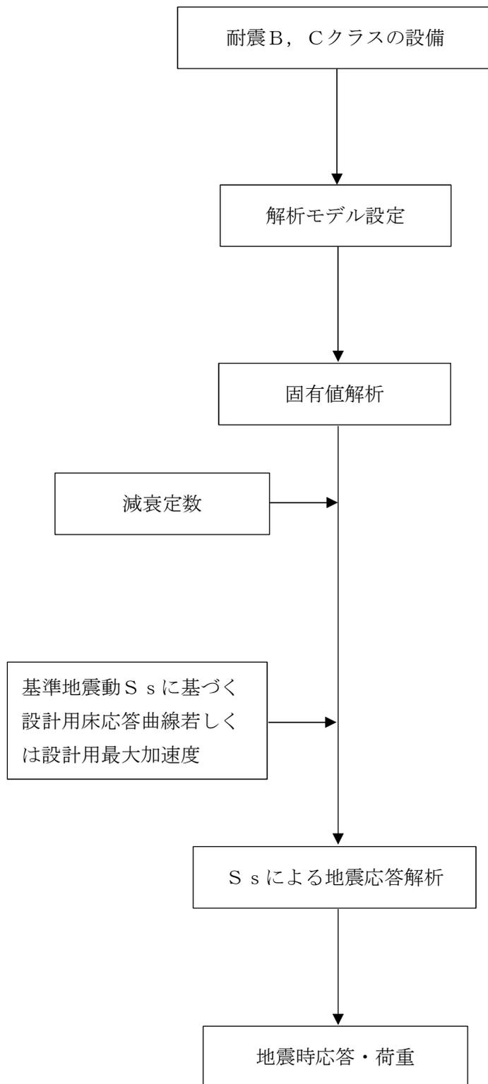
図4-1 耐震B, Cクラス機器の地震応答解析の手順
